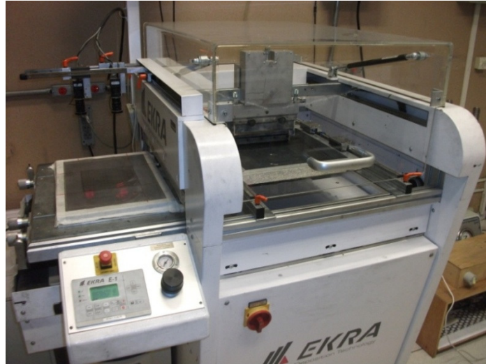
FIGURA 5.1-2 - Máquina EKRA modelo E-1 para impressão à tela da camada catalisadora em células a combustível. Adaptado de Andrea (2013)
