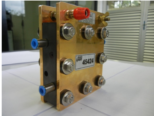
FIGURA 5.1-5 - Fotografia de uma célula a combustível do tipo PEM unitária produzida no IPEN
