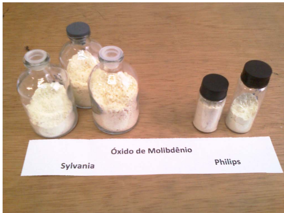
FIGURA 34 – Óxido de molibdênio obtido a partir dos Rejeitos S e P, pelo processo de destilação direta e calcinação do precipitado.
