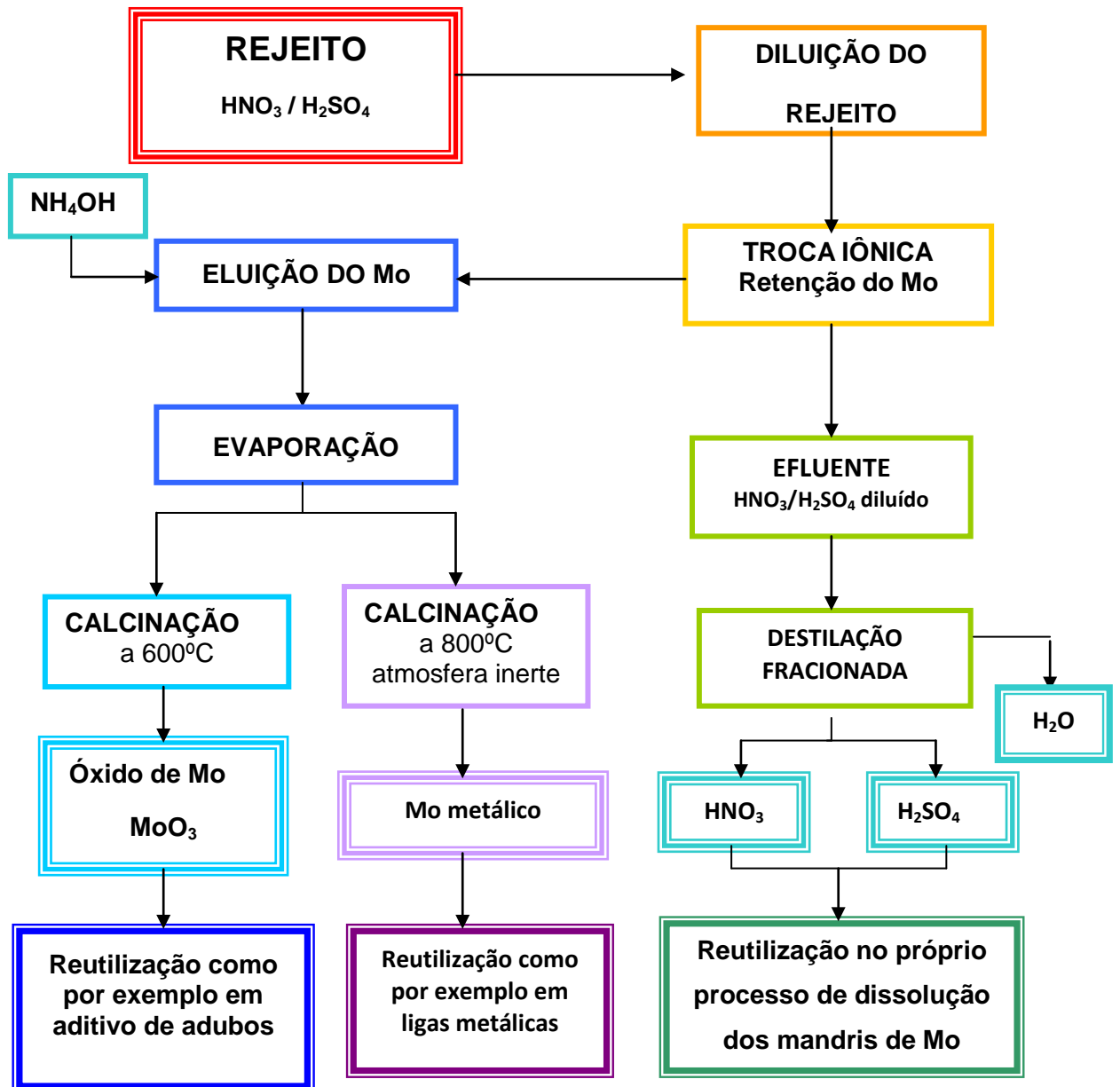
FIGURA 32 – Diagrama do primeiro processo proposto para a recuperação do Mo e dos ácidos nítrico e sulfúrico do rejeito proveniente das indústrias de lâmpadas incandescentes e fluorescentes.
