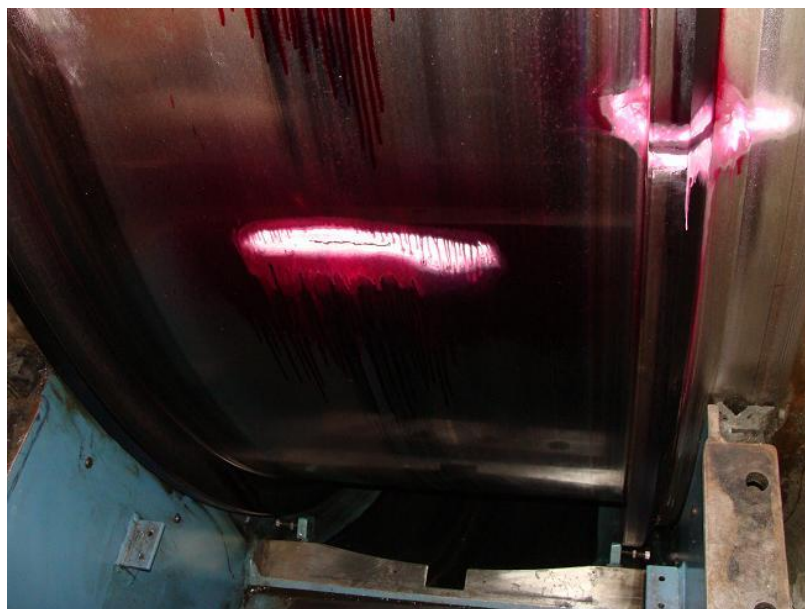
Figura 30 – Resultado do ensaio de líquido penetrante no munhão com a indicação de trincas
