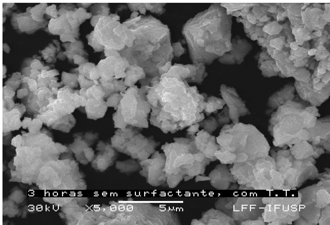
Figura 27 – Micrografia obtida por MEV (5000X) do pó magnético com tempo de moagem de 180 minutos e com tratamento térmico (após moagem) a 700°C por 30 min..
