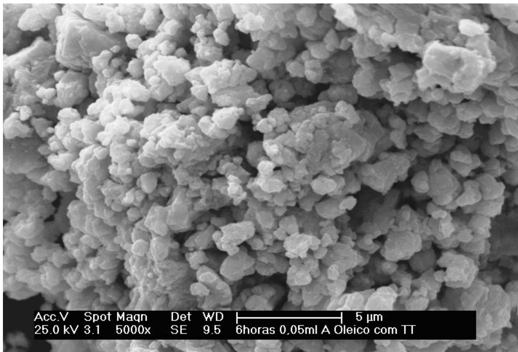
Figura 52 – Micrografia obtida por MEV (5000X) do pó magnético com tempo de moagem de 360 minutos, com adição de 0,05 ml de ácido oleico na moagem e tratamento térmico a 700°C por 30 min. após a moagem.
