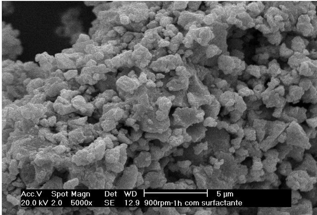
Figura 32 – Micrografia obtida por MEV (5000X) do pó magnético com tempo de moagem de 60 minutos.
