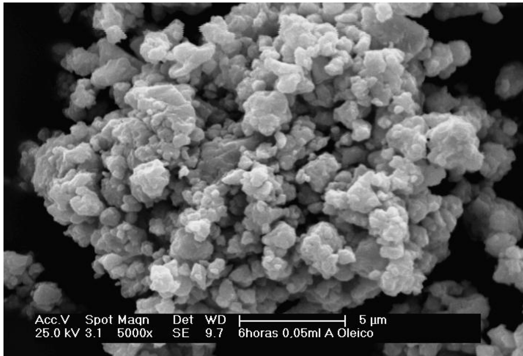
Figura 51 – Micrografia obtida por MEV (5000X) do pó magnético, obtidos após o processo de moagem, com adição de 0,05ml de ácido oleico, com tempo de moagem de 360 minutos.
