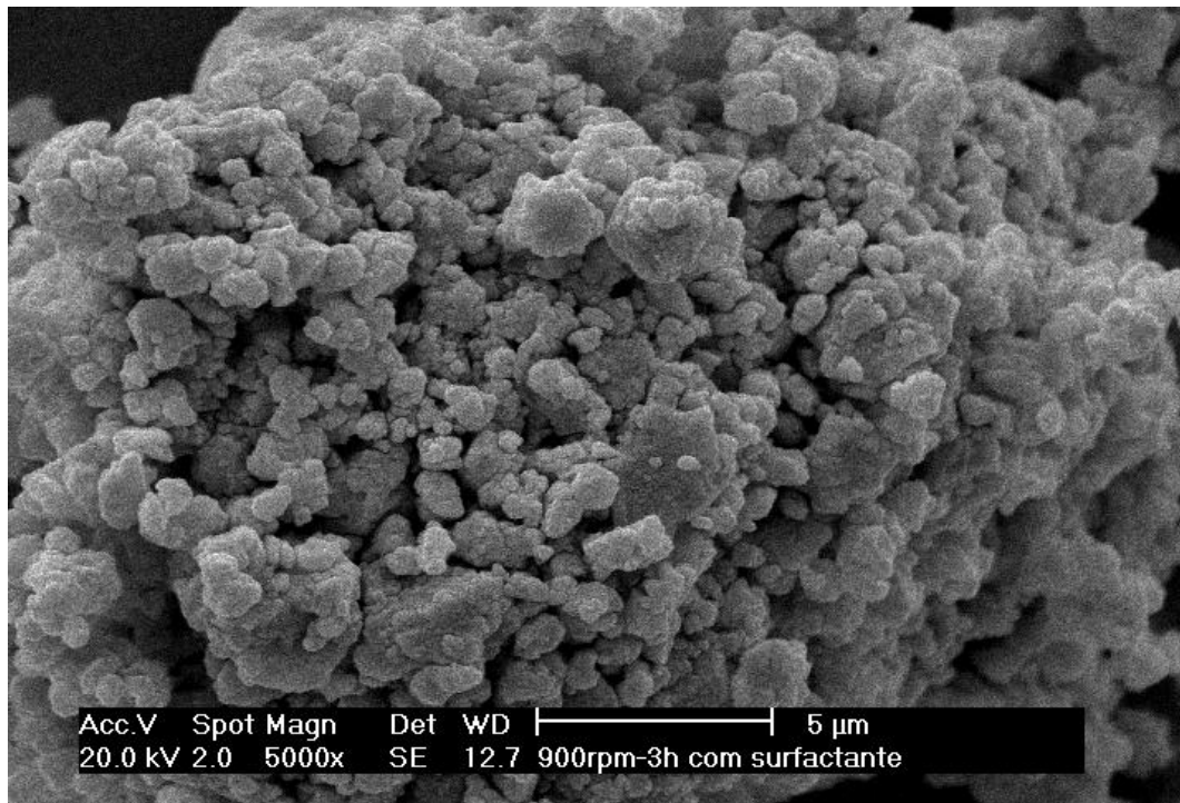
Figura 36 – Micrografia obtida por MEV (5000X) do pó magnético com tempo de moagem de 180 minutos.
