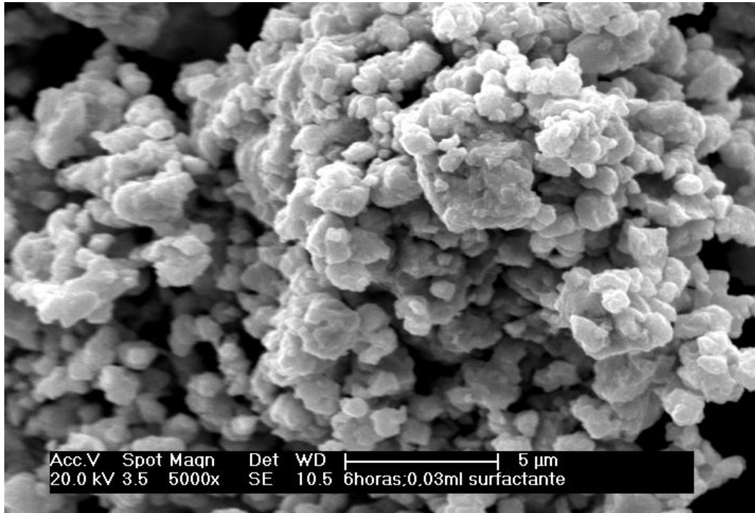
Figura 47 – Micrografia obtida por MEV (5000X) do pó magnético, obtidos após o processo de moagem, com adição de 0,03 ml de ácido oleico, com tempo de moagem de 360 minutos.
