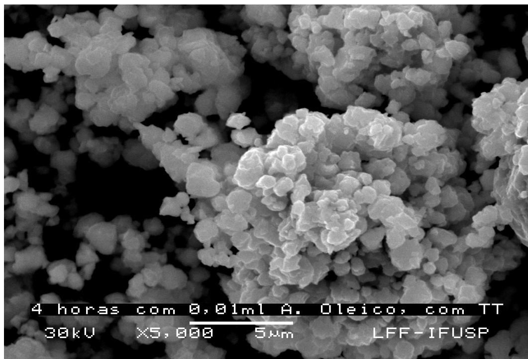
Figura 39 – Micrografia obtida por MEV (5000X) do pó magnético com tempo de moagem de 240 minutos e tratamento térmico (após moagem) a 700°C por 30 minutos.
