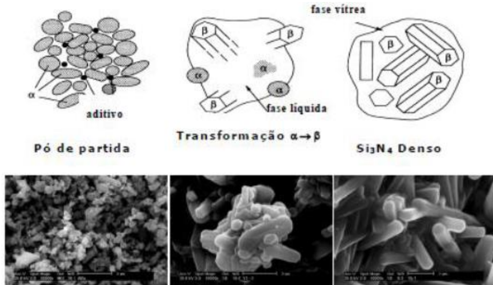
Figura 7: Esquema de transformação de fases \alpha \rightarrow \beta do nitreto de silício.
