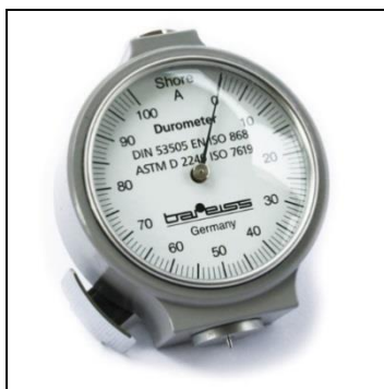
FIGURA 17: Aparelho utilizado para medidas de dureza shore A.
