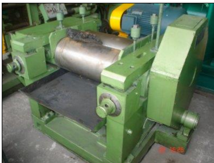
FIGURA 13: Misturador de cilindro aberto para o processamento das borrachas.
