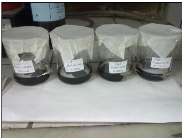
FIGURA 20: Ensaio de inchamento utilizando-se tolueno como solvente.
