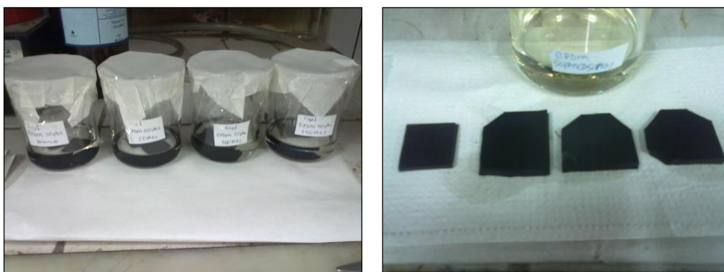
FIGURA 41: Foto do ensaio de inchamento da borracha EPDM.
