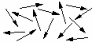
Figura 6 – Representação esquemática da orientação do campo magnético de um material paramagnético.
