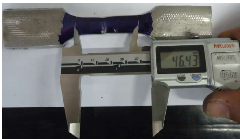
Figura 44 - Medida do comprimento final do corpo-de-prova.
