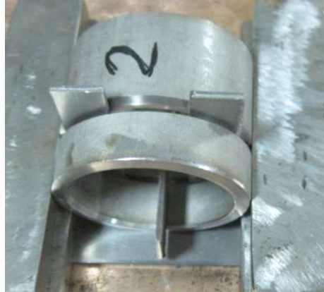
Figura 35 - Dispositivo utilizado para ponteamento.
