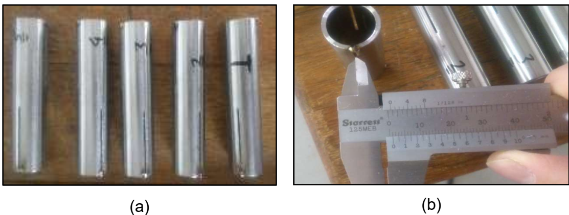
Figura 33 - Tubos numerados e ponteados. (a) tubos numerados; (b) medição do chanfro após ponteamto.
