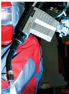
Figura 22 - Tocha modificada para o processo CMT® e buffer incluído no cabo da tocha (Modificado de Fronius CMT: Cold Metal Transfer ).
