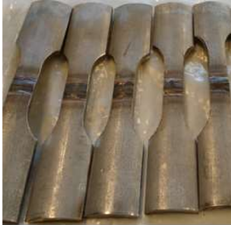
Figura 39 - Corpos de prova aplicados para a condição 12 usinados conforme norma ASME IX (12) .
