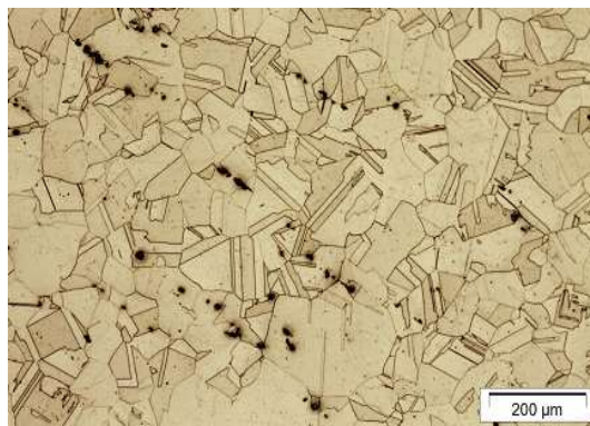
Figura 3 - Microestrutura típica do aço inoxidável austenítico (Cedido pela SGS-Grupo Labmat)
