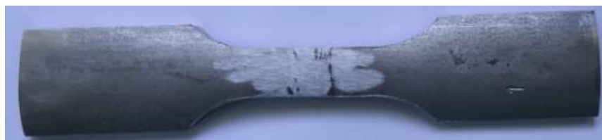
Figura 40 - Corpo de prova com o reforço da face removido por lixamento.
