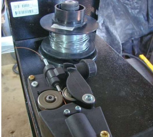
Figura 20 - Carretel com motor de corrente contínua, presente no alimentador de arame.
