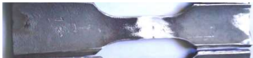
Figura 41 - Corpo de prova com o reforço da raiz removido por lixamento.
