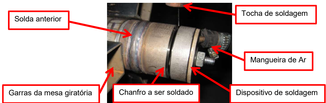
Figura 36 - Dispositivo utilizado para garantir a purga interna do tubo.
