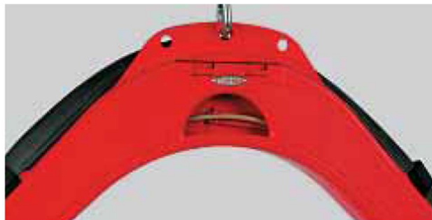
Figura 22 - Tocha modificada para o processo CMT® e buffer incluído no cabo da tocha (Modificado de Fronius CMT: Cold Metal Transfer ).
