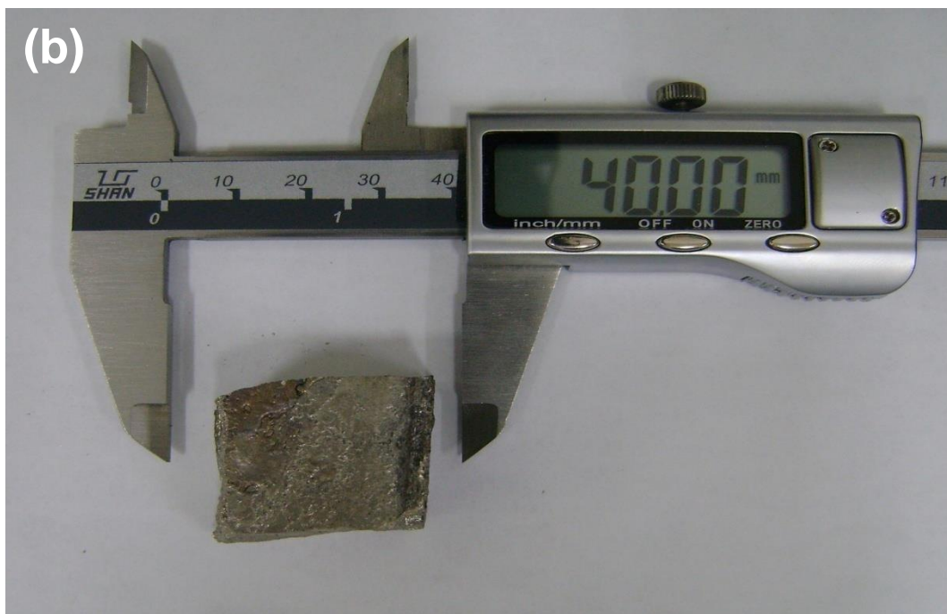
FIGURA 16 – (a) Liga metálica no estado bruto de fusão (b) 5g da liga metálica utilizada na hidrogenação.
