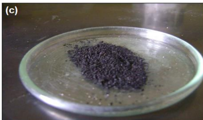
FIGURA 19 – Processo de fabricação do eletrodo negativo, onde: (a) pó da liga classificada <math>< 45\mu\text{m}</math>, (b) mistura de 67% em massa de carbono de alta área superficial e 33% em massa de PTFE e (c) mistura composta pela liga metálica, PTFE e carbono de alta área superficial.
