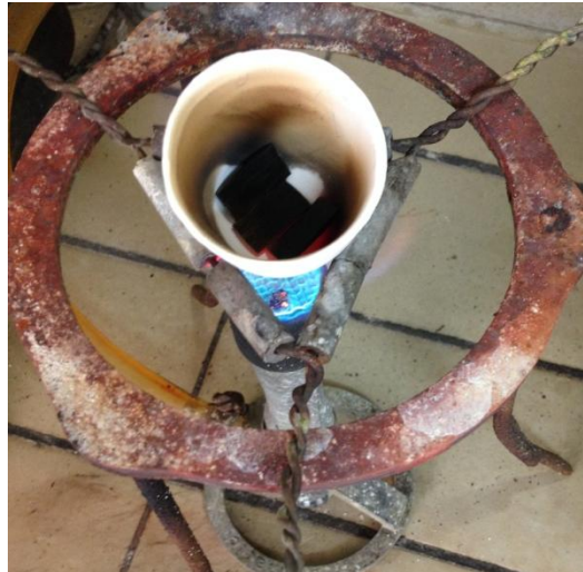
FIGURA 8 – Aquecimento de amostra do compósito epóxi/FB em bico de Bunsen.
