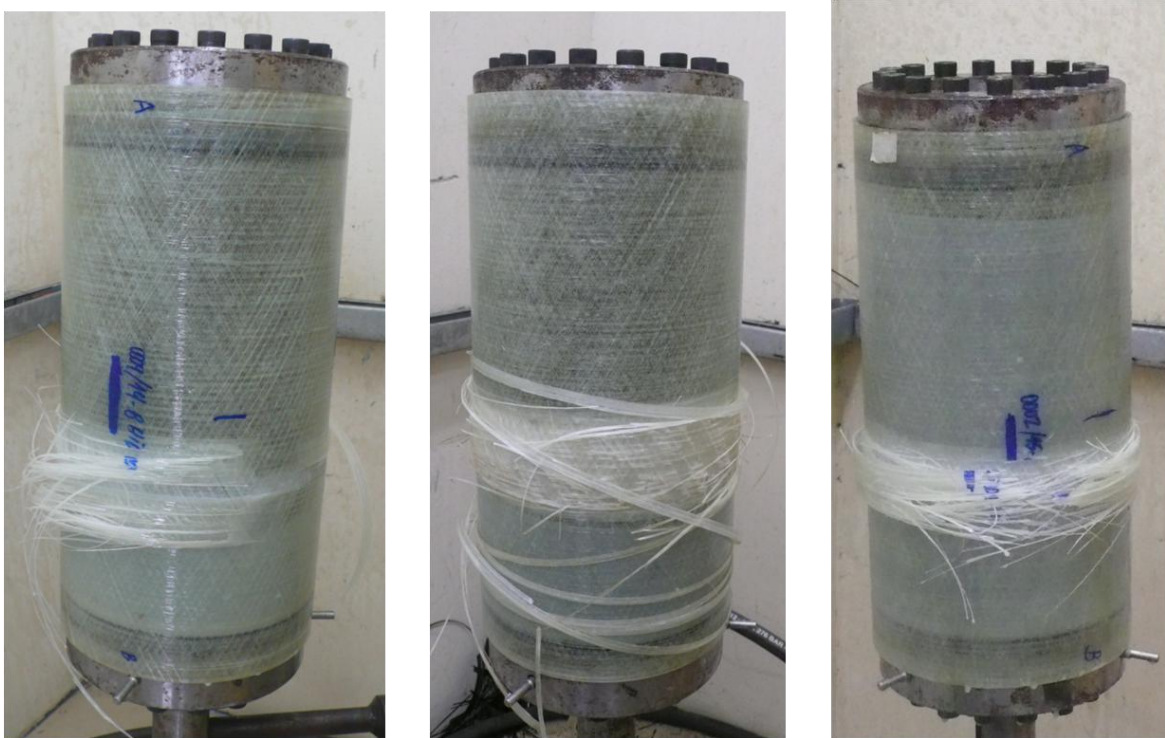
FIGURA 23 – Aspecto dos cilindros de compósito epóxi/FV após ensaio hidrostático.
