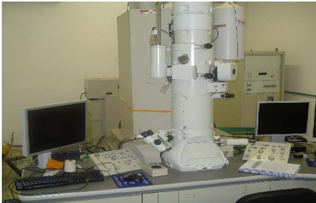
FIGURA 20: Microscópio eletrônico de transmissão analítico marca JEOL utilizado para análise das amostras de Ti-6Al-4V.
