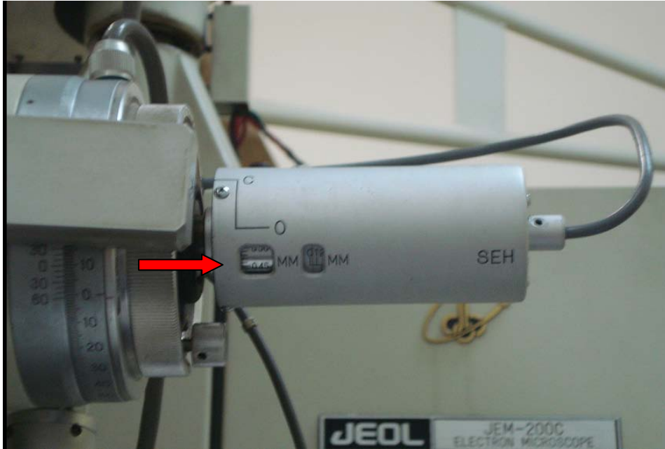
FIGURA 21: Detalhe do sistema de tração e obtenção de medidas utilizado para análise de tração in situ das amostras de Ti-6Al-4V.
