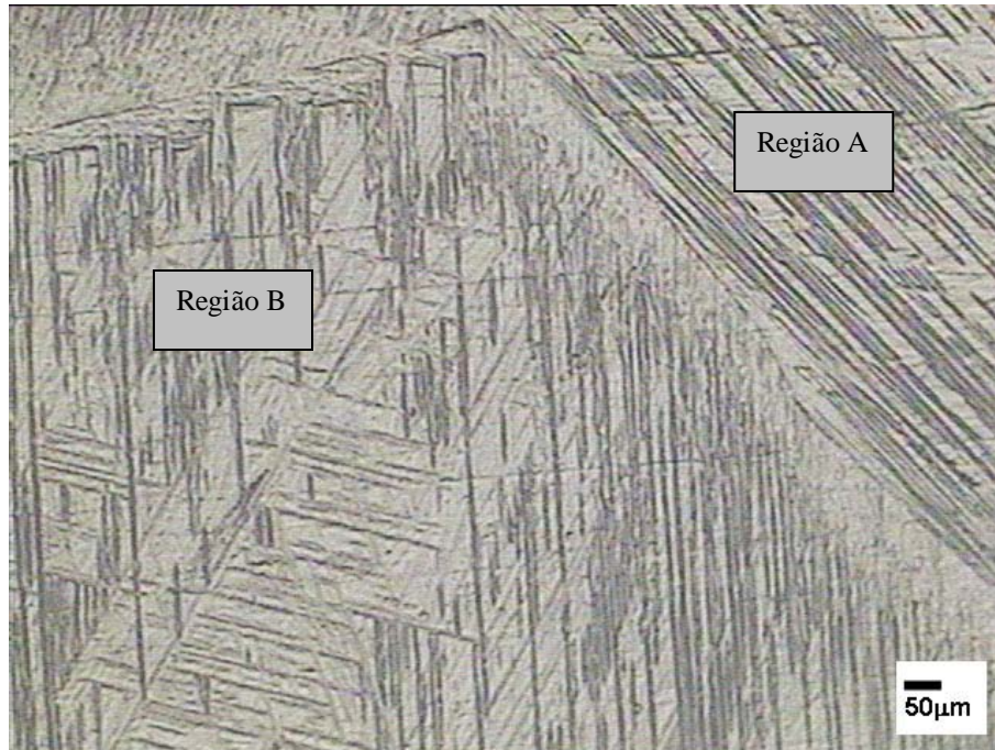
FIGURA 28: Micrografia Óptica da amostra de Ti-6Al-4V tratada termicamente a 1000 °C por duas horas e resfriada em água. Amostra submetida ao ataque por 90 segundos (10 mL HF, 10 mL HNO 3 e 85 mL H 2 O).
