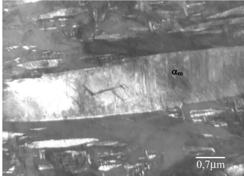
FIGURA 49: Micrografia obtida por Microscopia Eletrônica de Transmissão (MET) da amostra de Ti-6Al-4V (1000°C/2h), mostrando as lamelas \alpha e discordâncias (campo escuro).
