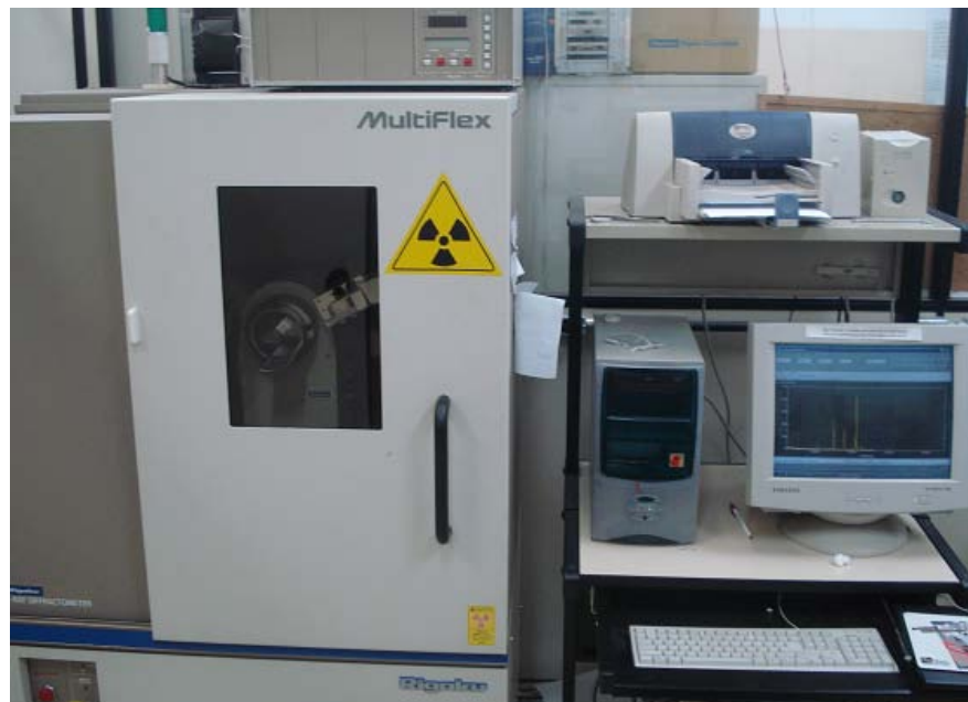
FIGURA 24: Difratorômetro de raios X marca RIGAKU utilizado para análise das amostras de Ti-6Al-4V.
