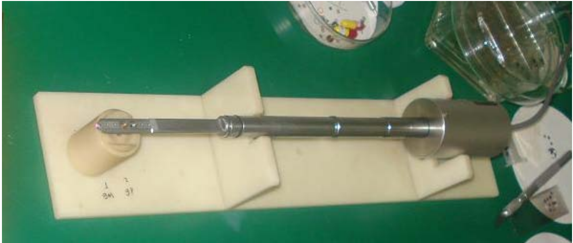
FIGURA 17: Porta amostra do Microscópio Eletrônico de Transmissão analítico (MET-AR) da marca JEOL utilizado para análise das amostras de Ti-6Al-4V.
