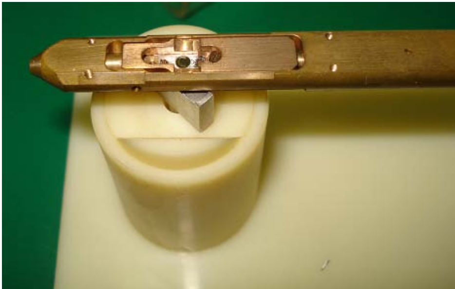
FIGURA 22: Porta-amostra para tração in situ do microscópio eletrônico de transmissão marca JEOL, com detalhe do sistema de tração e obtenção de medidas, utilizado para de análise tração das amostras de Ti-6Al-4V.
