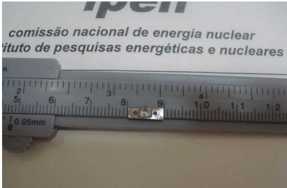
FIGURA 23: Detalhe da amostra de Ti-6Al-4V preparada para ensaio de tração in situ no microscópio eletrônico de transmissão marca JEOL.
