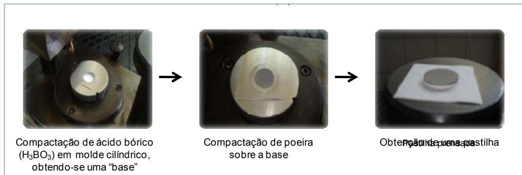
FIGURA 12 – Foto mostrando as etapas de preparação de pastilhas prensada de poeira para análises por WDXRF
