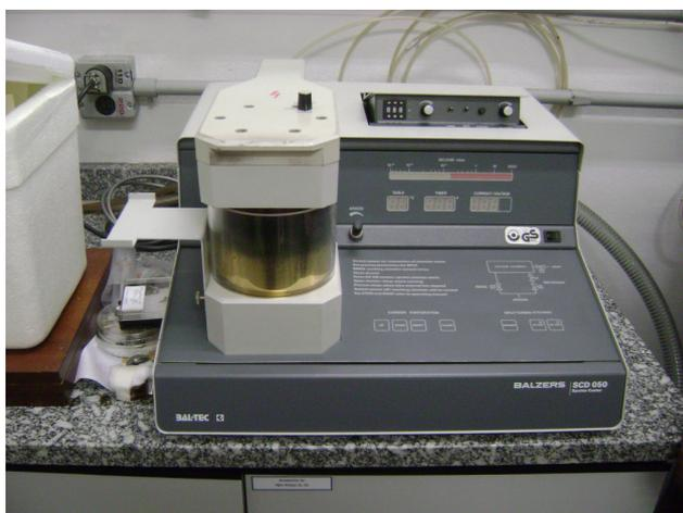
FIGURA 24. Sputter Coater Balzers SCD 050 (EPUSP) usado para revestir com ouro a seção transversal fracionada.
