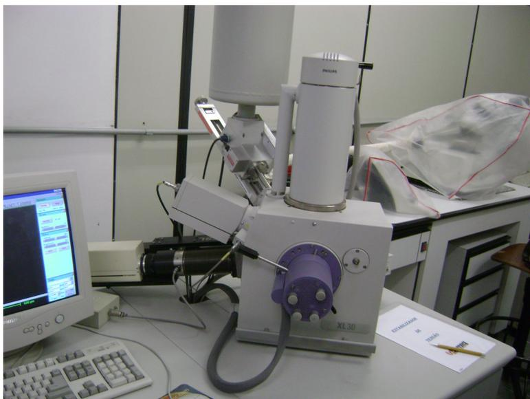
FIGURA 25. Microscópio Eletrônico de Varredura (MEV), marca Philips, modelo XL30 (EPUSP), para avaliar a morfologia celular fracionada (seção transversal).
