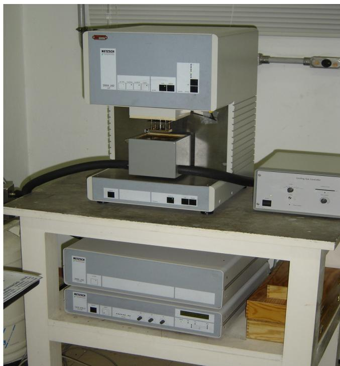
FIGURA 33. DMA - Analisador Mecanodinâmico Netzsch 242.
