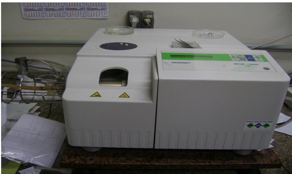
FIGURA 15. TGA/SDTA 851 Analisador termo-gravimétrico, Mettler-Toledo
