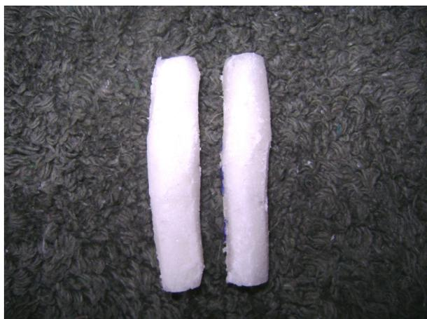
FIGURA 29. Amostra espumada de HMSPP, “preparada” para o teste de densidade.
