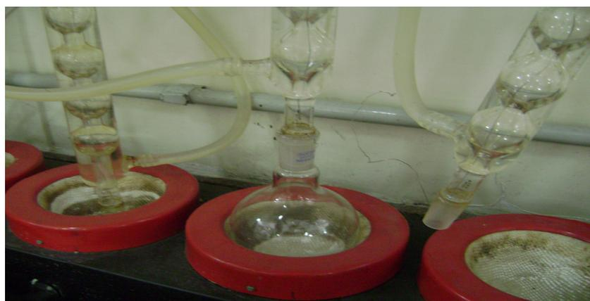
FIGURA 17. Vista parcial da aparelhagem usada no teste de teor de gel
