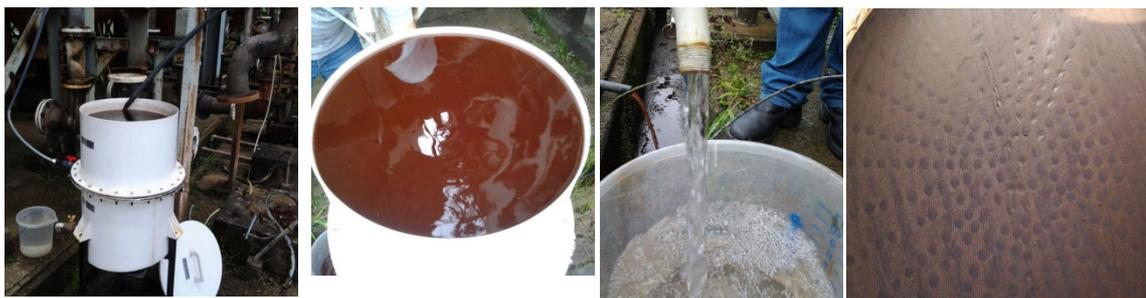
FIGURA 31 – Filtragem a vácuo do efluente ozonizado, saída do líquido filtrado e sólidos retidos no filtro.
