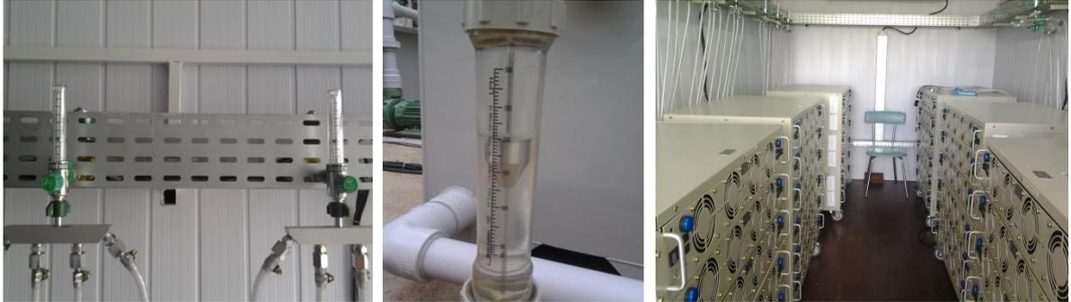
FIGURA 29 – (Da esquerda para direita) válvula de ajuste de  $\text{O}_2$ , manômetro de ajuste de vazão de efluente e gavetas com dielétricos
