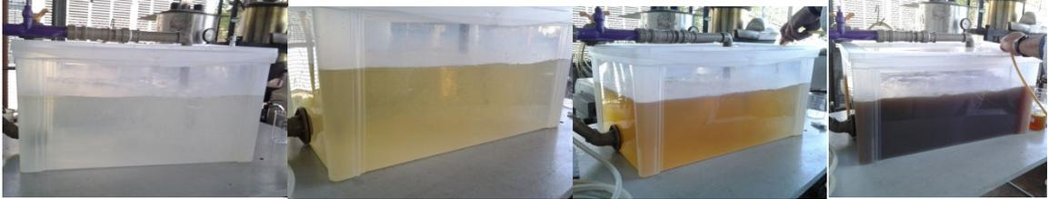
FIGURA 37 Mudança de coloração durante o processo de oxidação dos efluentes do início até 60 minutos de aplicação de  $O_3$
