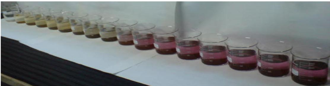
FIGURA 39 - Após sedimentação vista da coloração rosada do permanganato
