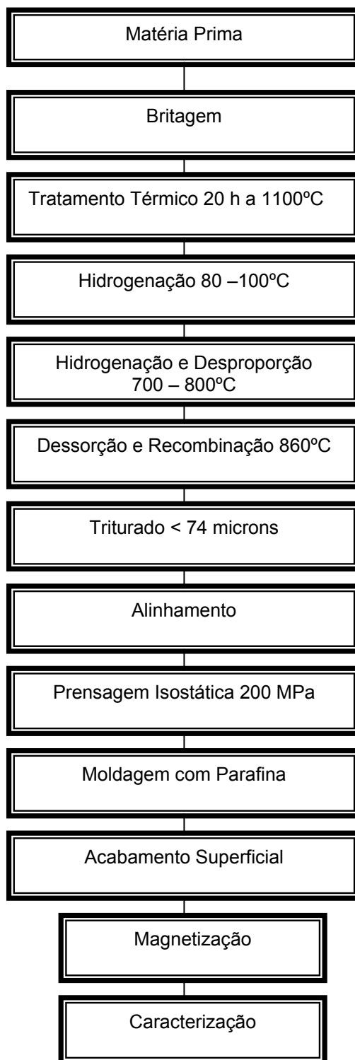
Figura 6. Fluxograma do processo de preparação dos ímãs empregando o processo HDDR.
