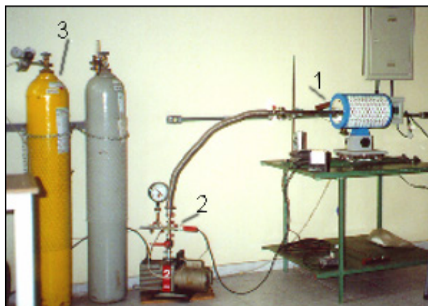
Figura 7. Sistema e preparação de pós HDDR (1) retorta e forno para tratamento HDDR, (2) sistema de vácuo mecânico e (3) cilindro de gás \text{H}_2 .
