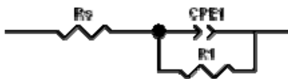
Figura 38. Circuito elétrico equivalente utilizado para o ajuste dos dados experimentais obtidos para a amostra de \text{Pr}_{14}\text{Fe}_{\text{bal}}\text{Co}_{16}\text{B}_6\text{Nb}_{0,1}\text{P}_{0,01} .
