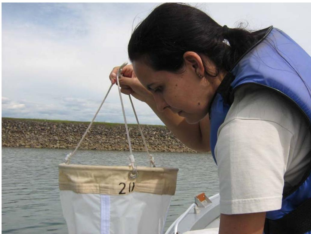
Foto 7 – Coleta do fitoplâncton, com rede de plâncton de 20  $\mu\text{m}$ .
