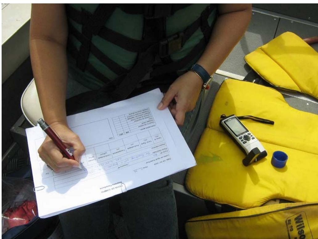
Foto 6 – Anotação dos dados obtidos, com sonda Horiba U-10 e GPS, em ficha de campo.
