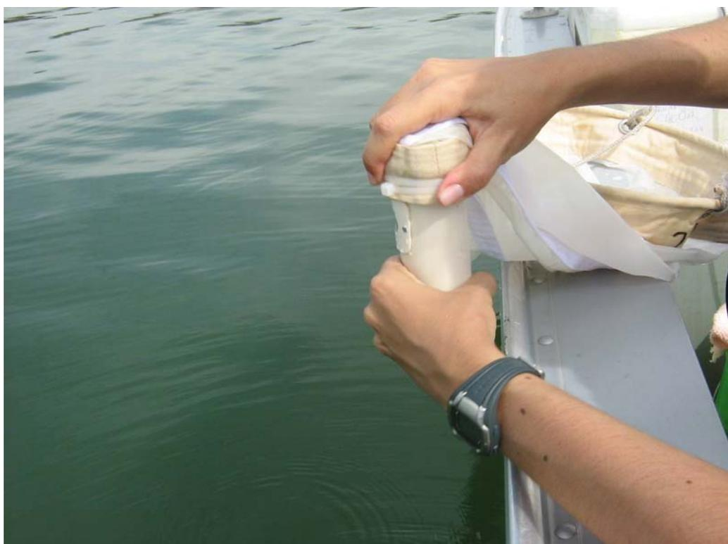
Foto 8 – Coleta do material planctônico retido na rede.
