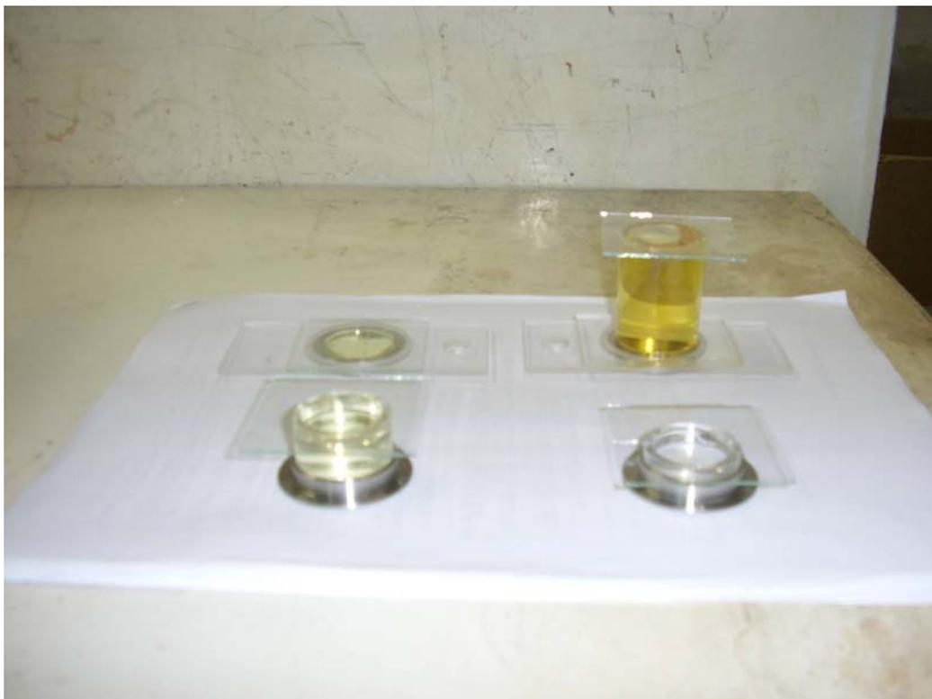
Foto 9 – Sedimentação das amostras quantitativas de fitoplâncton em câmaras de Utermöhl.
