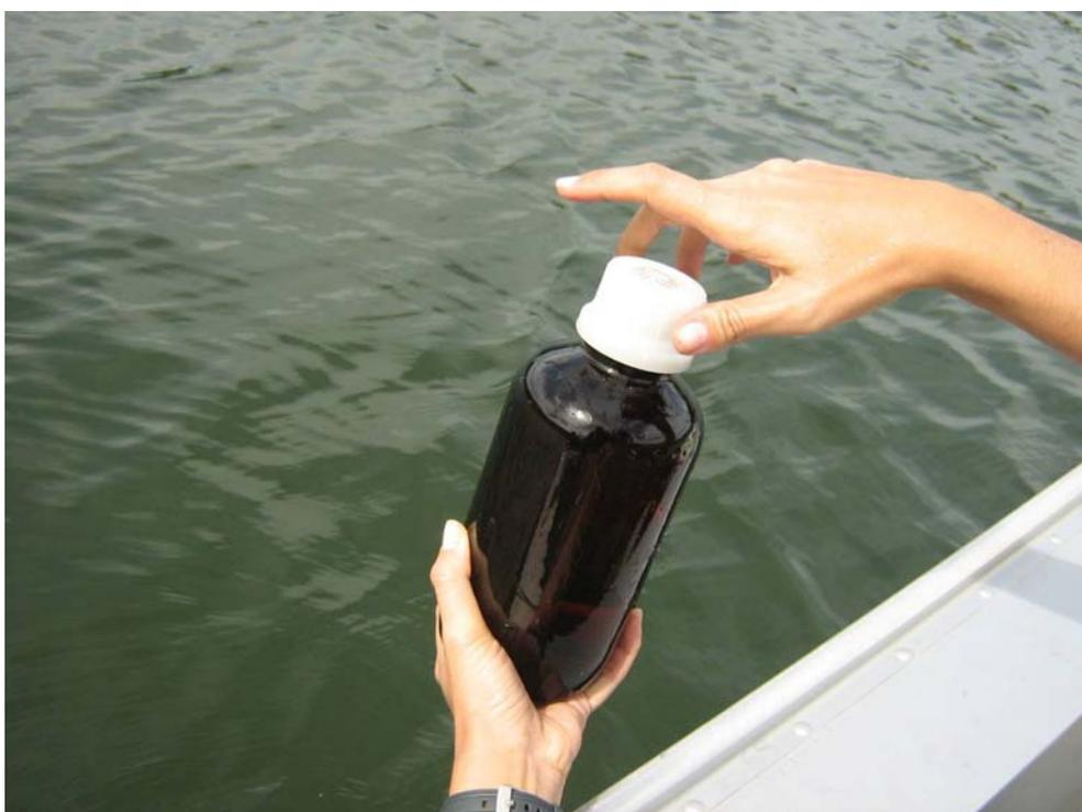
Foto 4 – Coleta da água, em frasco de vidro âmbar, para as análises físico-químicas.
