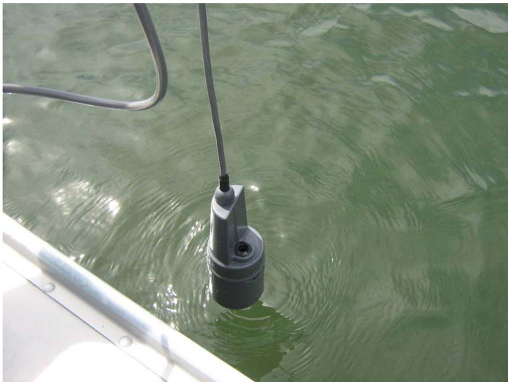
Foto 5 – Obtenção de dados com sonda multiparamétrica Horiba U-10.
