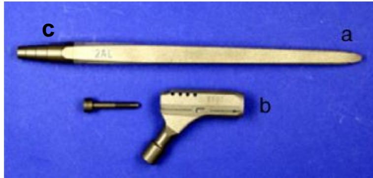
Figura 11 - Prótese ortopédica de fêmur. A parte proximal (b) encaixa-se na distal (a), formando uma região de fresta (c). (RECLARU et al. , 2014).
