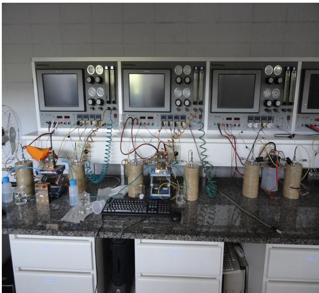
Figura 4.4. Estação de Teste da Electrocell para os estudos em uma célula a combustível.
