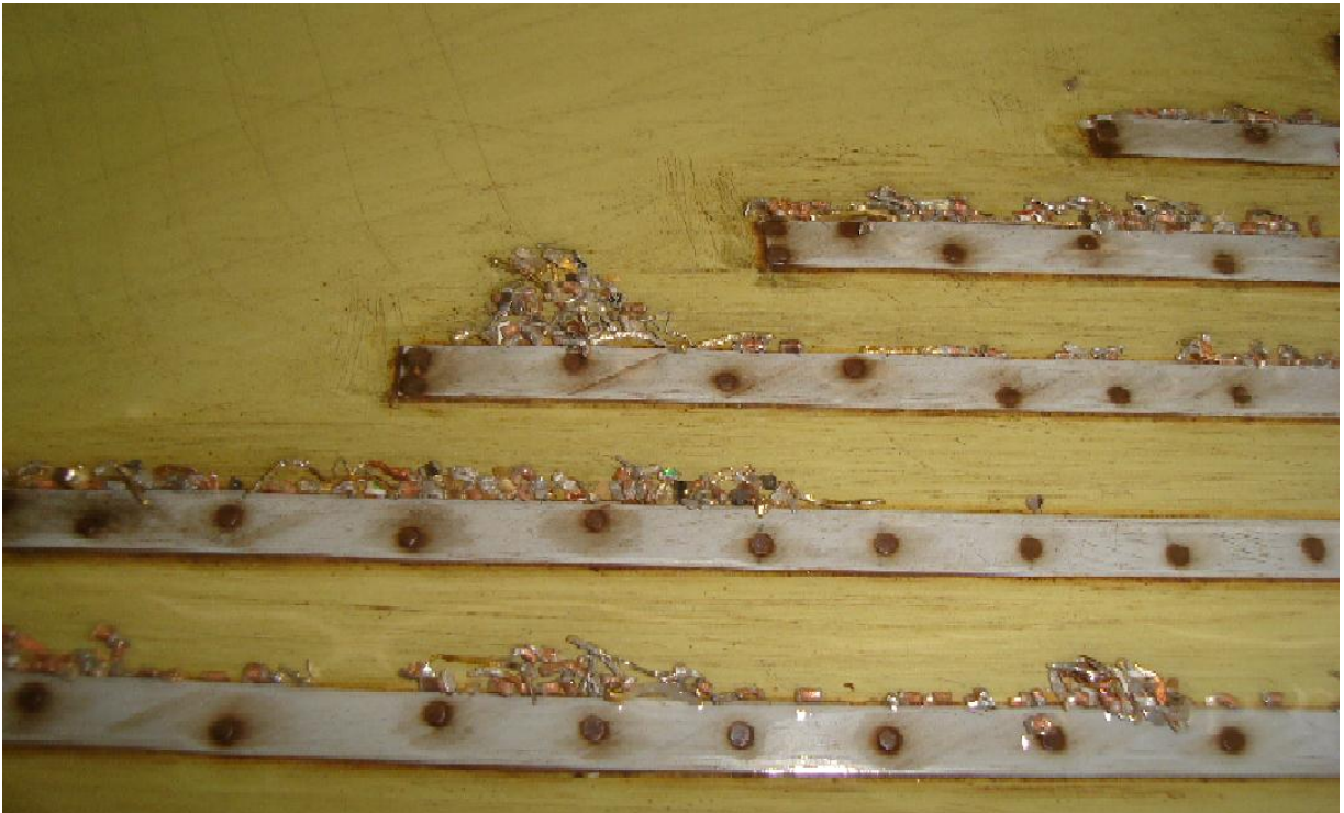
Figura 4.2 - Material em formato lamelar nos rifles da mesa vibratória.
