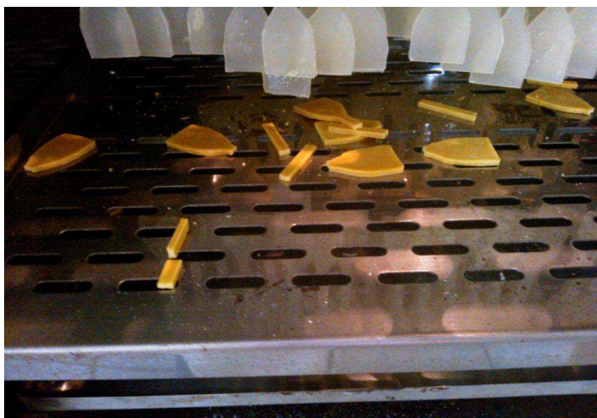
FIGURA 19 : Amostras soltas dentro da estufa, devido ao avançado estado de degradação
