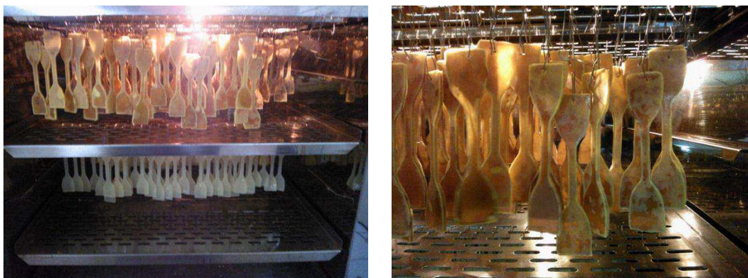
FIGURA 18: Amostras dispostas dentro da estufa
