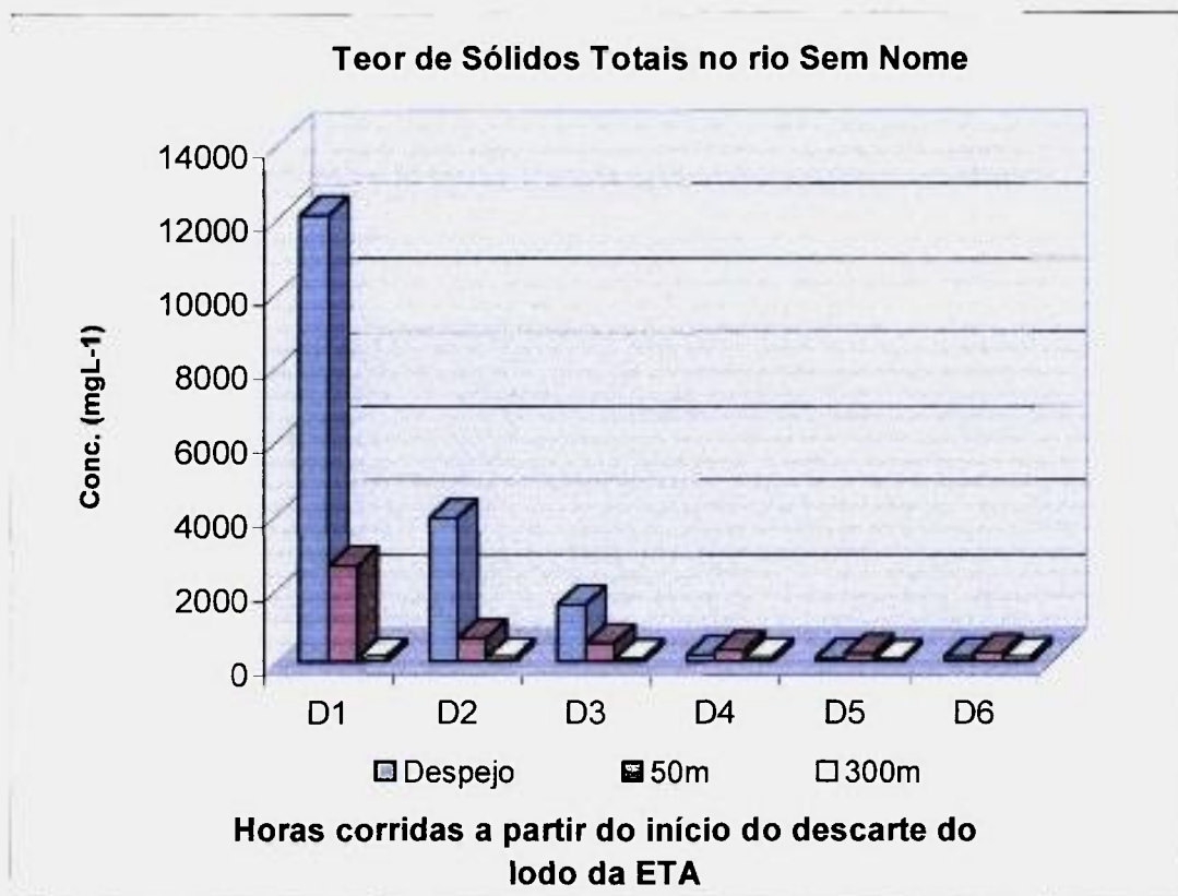
FIGURA 41 – Avaliação do teor de sólidos totais no córrego receptor até seis horas (D1 a D6) do início do descarte da ETA.
