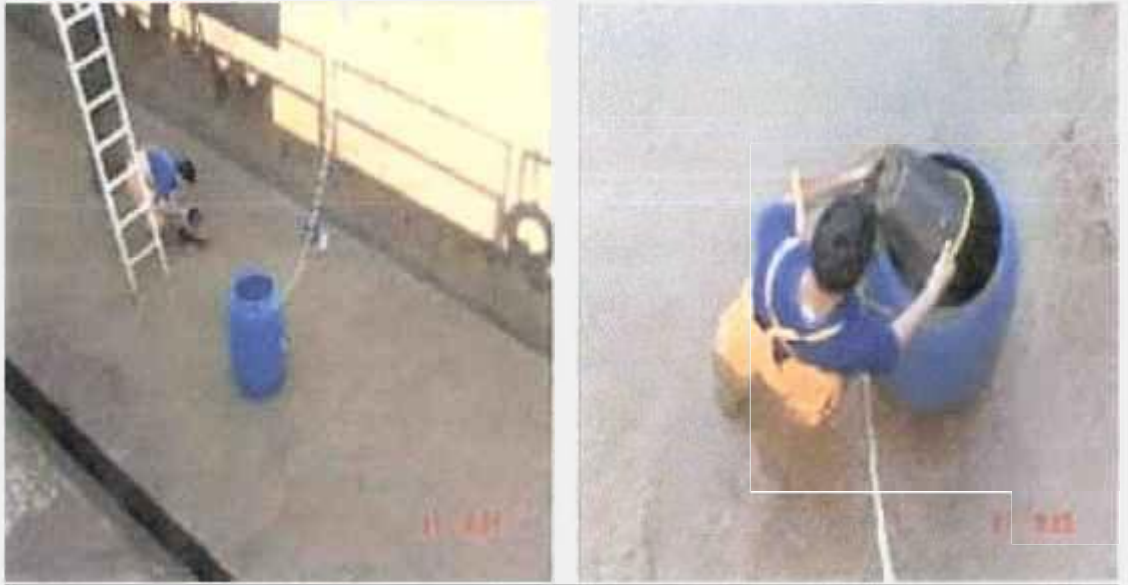
FIGURAS 14 e 15 - Coleta de amostras de lodo de ETA no tanque de decantação, seguido de homogeneização para amostra representativa.
