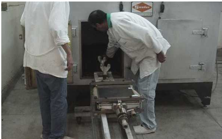
Figura 4.3.7- Conjunto mandril–placas de prensagem sendo colocado na estufa.
