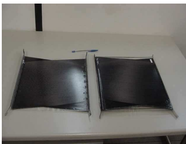
Figura 4.3.8- Placas após cura e corte para retirada do mandril.
