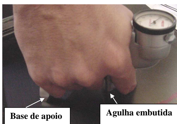
Figura 4.4.2 Medida da dureza Barcol de uma placa de compósito de fibra de carbono.
