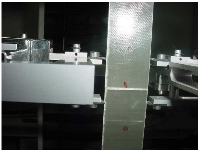
Figura 5.5.4- Aspecto da fratura em ensaio de tração de um corpo-de-prova de fibra de vidro com bobinagem a 90^\circ .
