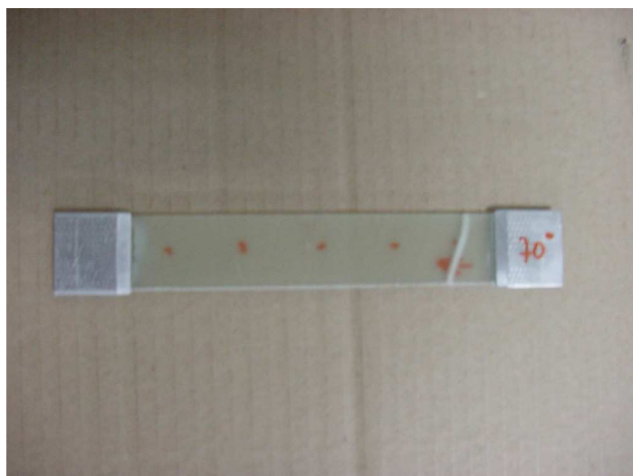
Figura 5.5.6- Aspecto da fratura em ensaio de tração de um corpo-de-prova de fibra de vidro com bobinagem a \pm 70^\circ .
