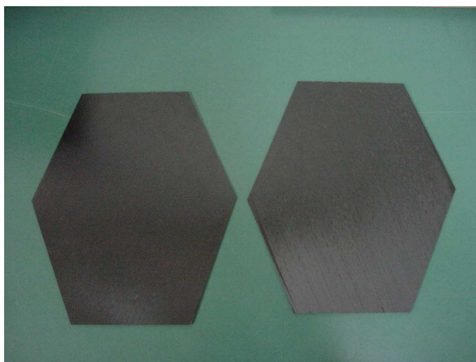
Figura 4.7.2- Placas bobinadas a \pm 80^\circ após corte para obtenção de área útil.
