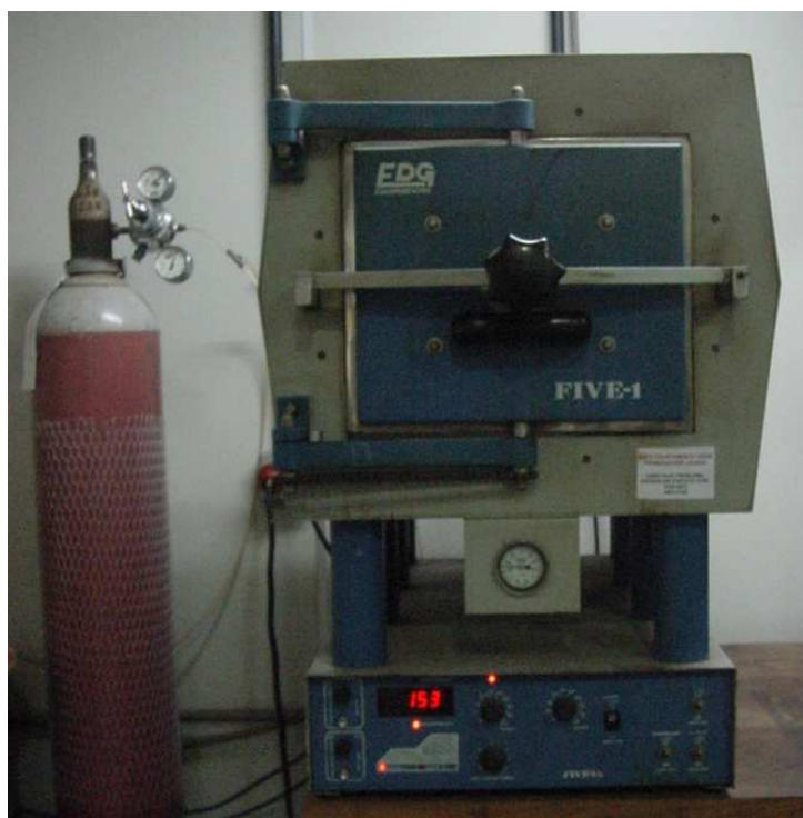
Figura 4.5.2- Forno e cilindro de nitrogênio utilizados na queima das amostras.
