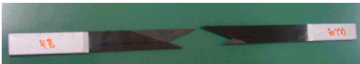
Figura 5.5.5- Aspecto da fratura em ensaio de tração de um corpo-de-prova de fibra de carbono com bobinagem a \pm 20^\circ .
