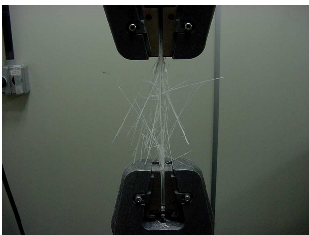
Figura 5.5.3- Aspecto da fratura em ensaio de tração de um corpo-de-prova de fibra de vidro com bobinagem a 0^\circ .
