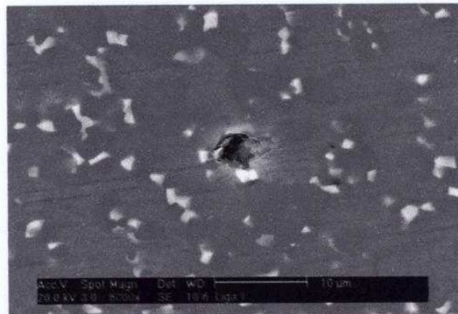
Figura 4.76. Micrografia obtida por MEV, mostrando uma outra região da microestrutura da liga 1, onde pode ser observado um poro.
