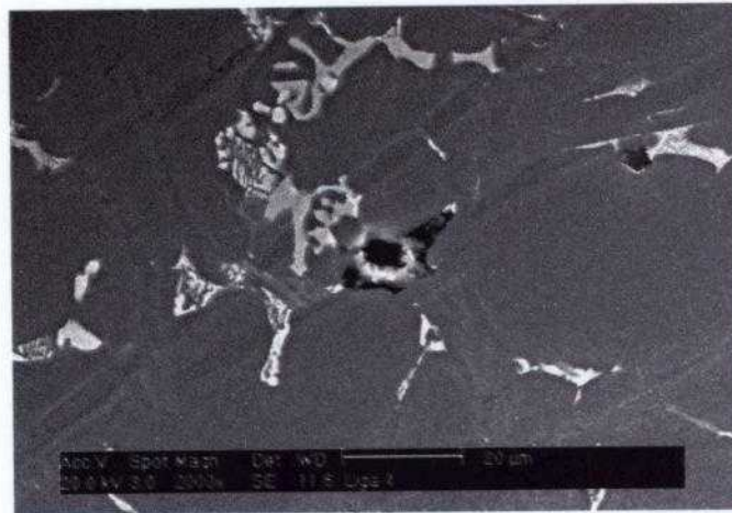
Figura 4.82. Microestrutura da liga 4, mostrando que o processo de corrosão inicia-se pelo ataque ao precipitado rico em Mg.
