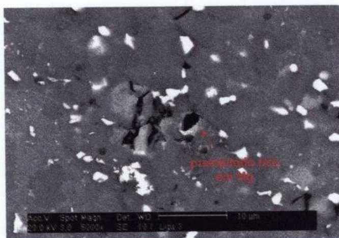
Figura 4.80. Microestrutura da liga 3, mostrando que o processo de corrosão inicia-se pelo ataque ao precipitado rico em Mg.
