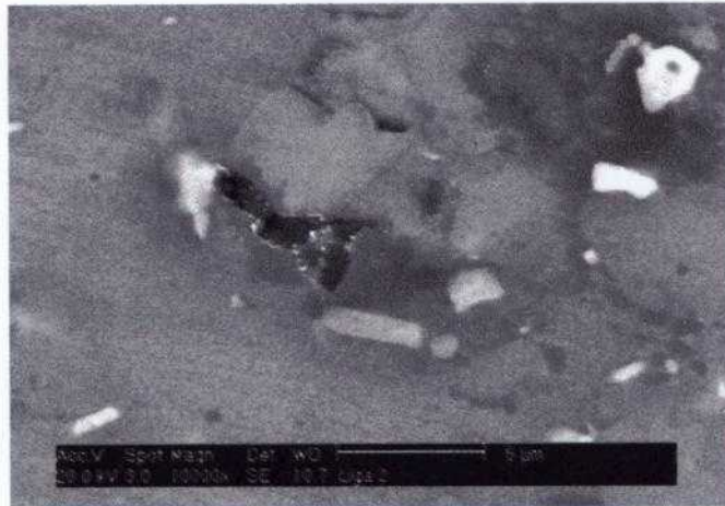
Figura 4.79. Imagem de outra região da microestrutura da liga 2, mostrando também o ataque do precipitado rico em Mg.
