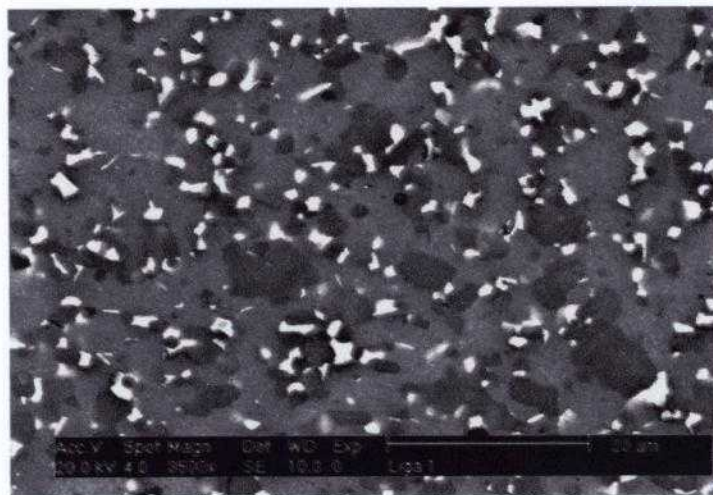
Figura 4.18. Microestrutura da liga 1 observada por MEV, utilizando detector de elétrons secundários (SE), que permite observar a fase de Si primário (região cinza escuro), a matriz de Al (região cinza) e os precipitados brancos.
