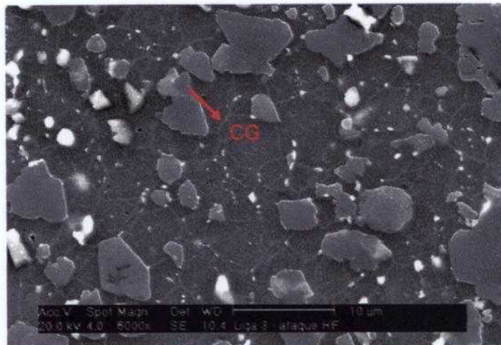
Figura 4.17. Microestrutura da liga 3 observada por microscopia eletrônica de varredura utilizando detector de elétrons secundários (SE). O ataque com HF revelou o contorno de grão (CG) da matriz de Al.
