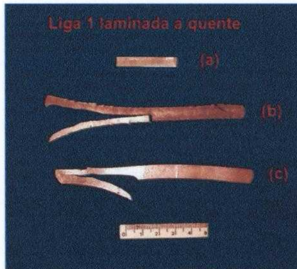
Figura 3.2. Macrografia da liga 1 como recebida (a), e após laminação a quente com dois passes por vez no laminador de ourives (b) e (c), com um passe de cada vez.
