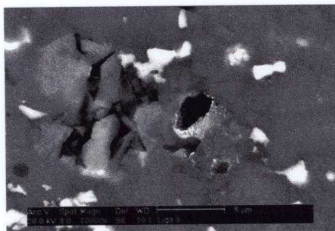
Figura 4.81. Detalhe da Figura 4.80, com aumento maior, para melhor visualizar o ataque ao precipitado rico em Mg.
