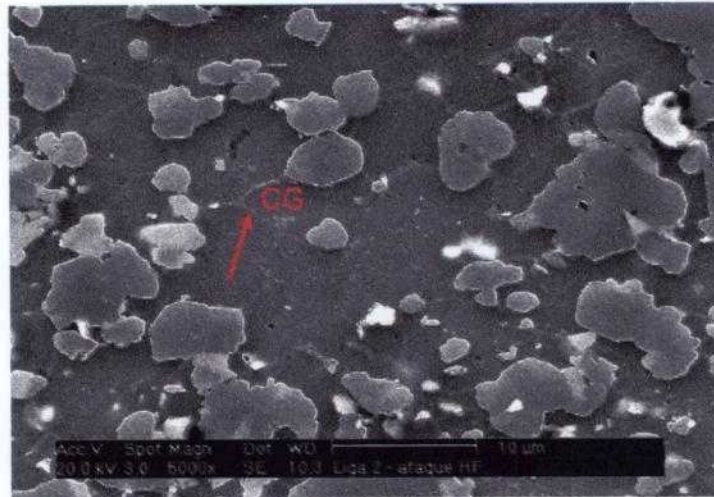
Figura 4.16. Microestrutura da liga 2 observada por microscopia eletrônica de varredura utilizando detector de elétrons secundários (SE). O ataque com HF revelou o contorno de grão (CG) da matriz de Al.
