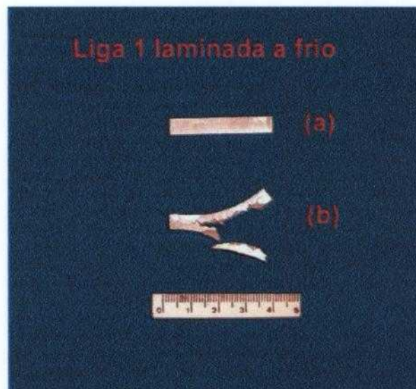
Figura 3.3. Macrografia da liga 1 como recebida (a), e após laminação a frio (b).
