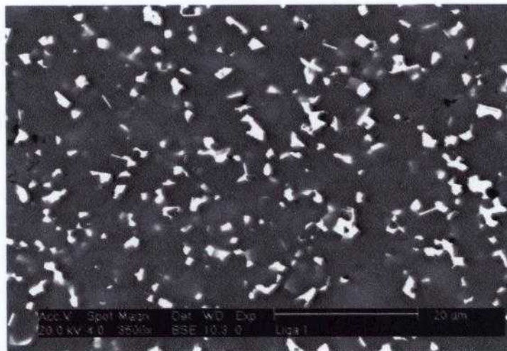
Figura 4.20. Microestrutura da liga 1 observada por MEV utilizando detector de elétrons retroespalhados (BSE), que permite a observação com melhor definição dos precipitados brancos distribuídos homogeneamente.
