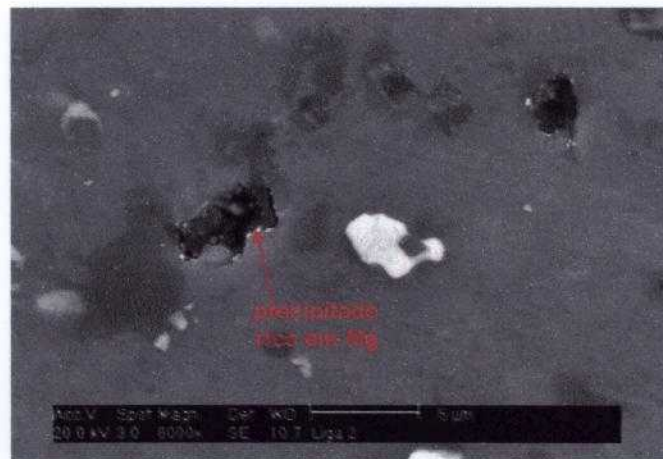
Figura 4.78. Microestrutura da liga 2, mostrando que o processo de corrosão inicia-se pelo ataque ao precipitado rico em Mg.
