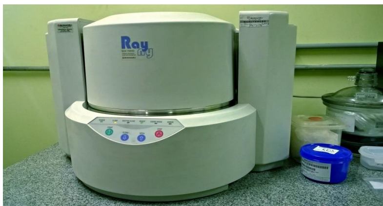
Figura 08 – EDXRF-700HS, da marca SHIMADZU Co
