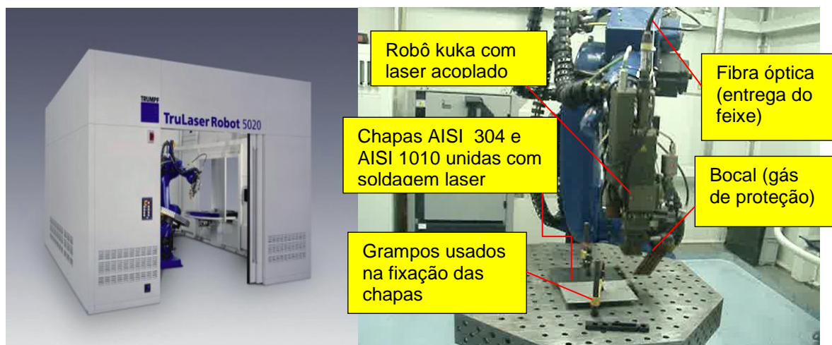
FIGURA 15 - Equipamento utilizado na soldagem laser
