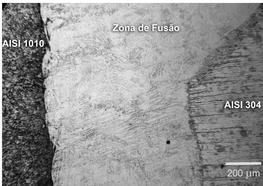
FIGURA 33 - Microscopia óptica amostra 1, região Zona de Fusão
