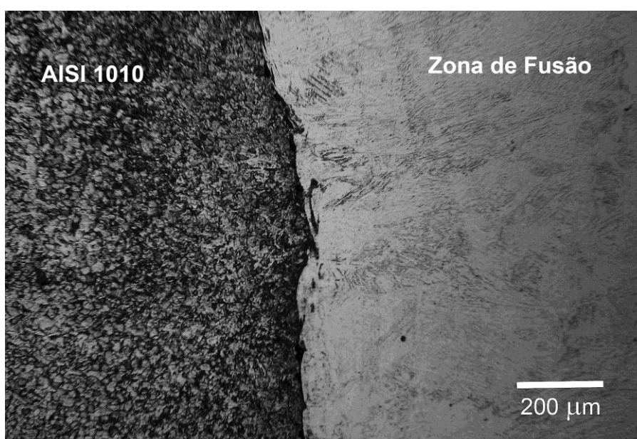
FIGURA 32 - Microscopia óptica amostra 1, região AISI 1010-Zona de Fusão
