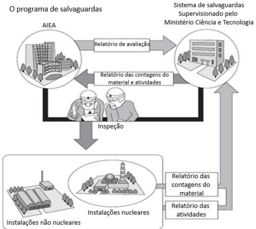
FIGURA 5: Fluxograma dos procedimentos de um sistema de salvaguardas aplicados pela AIEA (FEPC, 2002).
