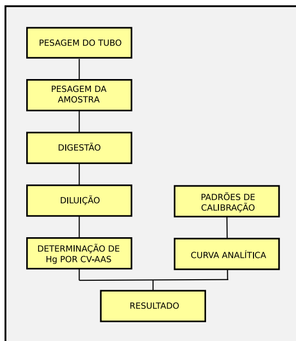
Figura 7.1.: Fluxograma das etapas do procedimento que contribuem para a incerteza na determinação de Hg em urina.
