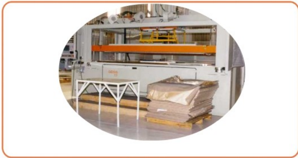
FIGURA 12 – Molde utilizado para conformação de peças em ABS por vacuum forming (Tecnofibras, Produtos, 2008).
