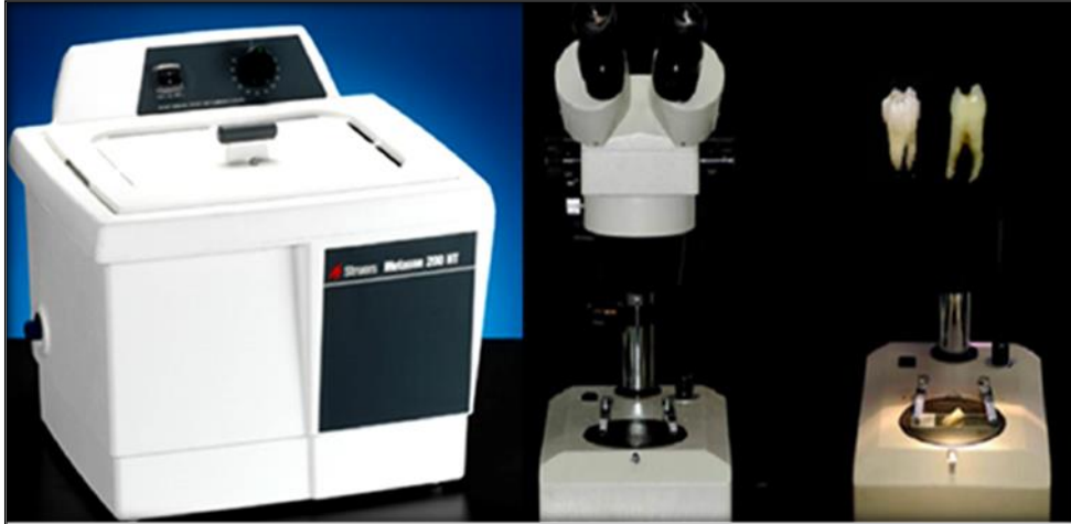
Figura 3 - A. Cuba ultra-sônica Metason 120T da Struers, B. Lupa estereoscópica Lambda LEB-3 (10X).
