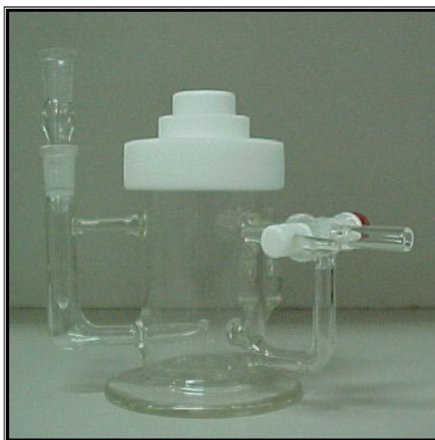
Figura 9 - Fotografia da célula eletroquímica utilizada
