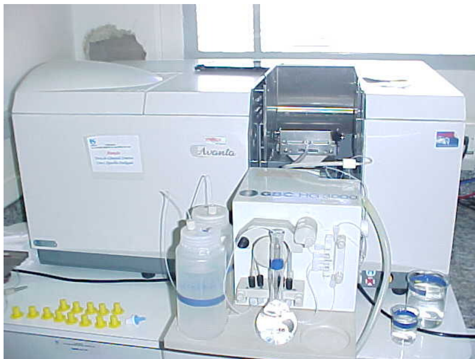
Figura 15: Espectrofotômetro de Absorção Atômica GBC modelo AVANTA com gerador de hidretos modelo CG – GH – 3000. (Laboratório RTOC-L – SABESP)
