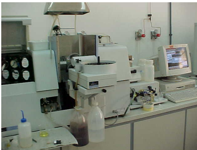
Figura 14: Espectrofotômetro de Absorção Atômica Perkin Elmer modelo AANALYST 800 com forno de grafite com aquecimento transversal, com correção de background por efeito Zeeman longitudinal. (Laboratório CQMA-IPEN)
