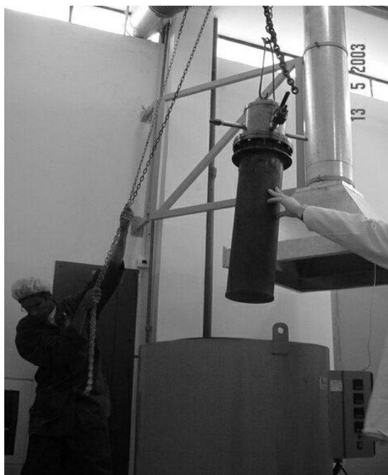
Figura 21. Reator de redução, posicionamento em forno poço.
