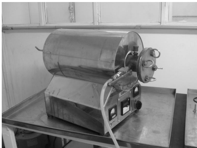
Figura 28. Forno tubular para tratamento térmico da liga U-10Mo.
