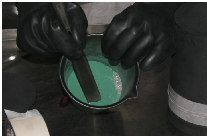
Figura 19. Detalhe mistura UF_4 (pó verde)+Mg(grãos prateados).
