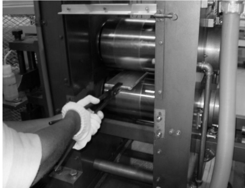
Figura 33. Laminação do conjunto U-10Mo/AA1050.
