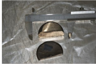
Figura 29. Evidência de formação de oxidação na liga U-10Mo, quando exposta ao ar, por um dia.
