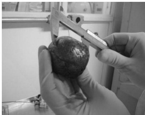
Figura 26. Tarugo de U-Mo produzido por fusão a indução.
