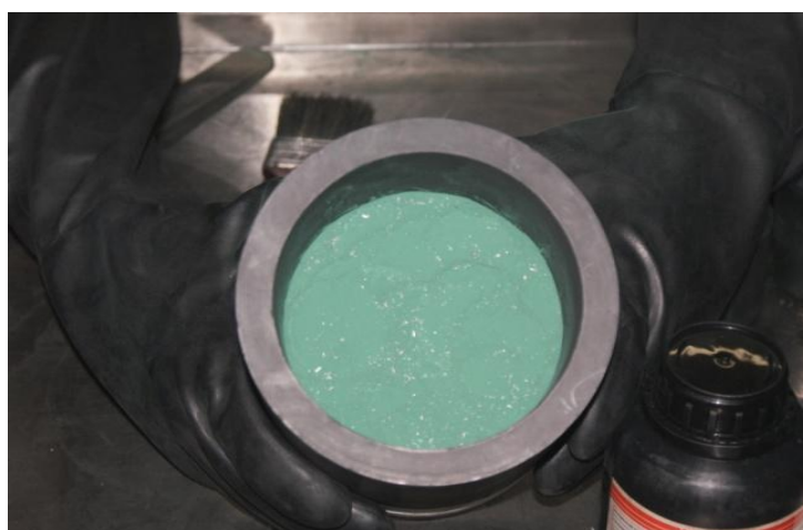
Figura 20. Detalhe do cadinho de grafite contendo a mistura UF_4 +Mg.
