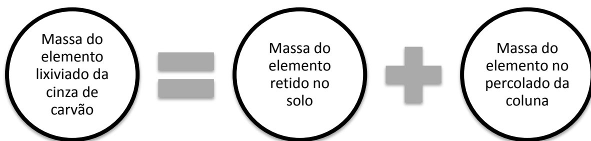
FIGURA 21 – Esquema do balanço de massa
