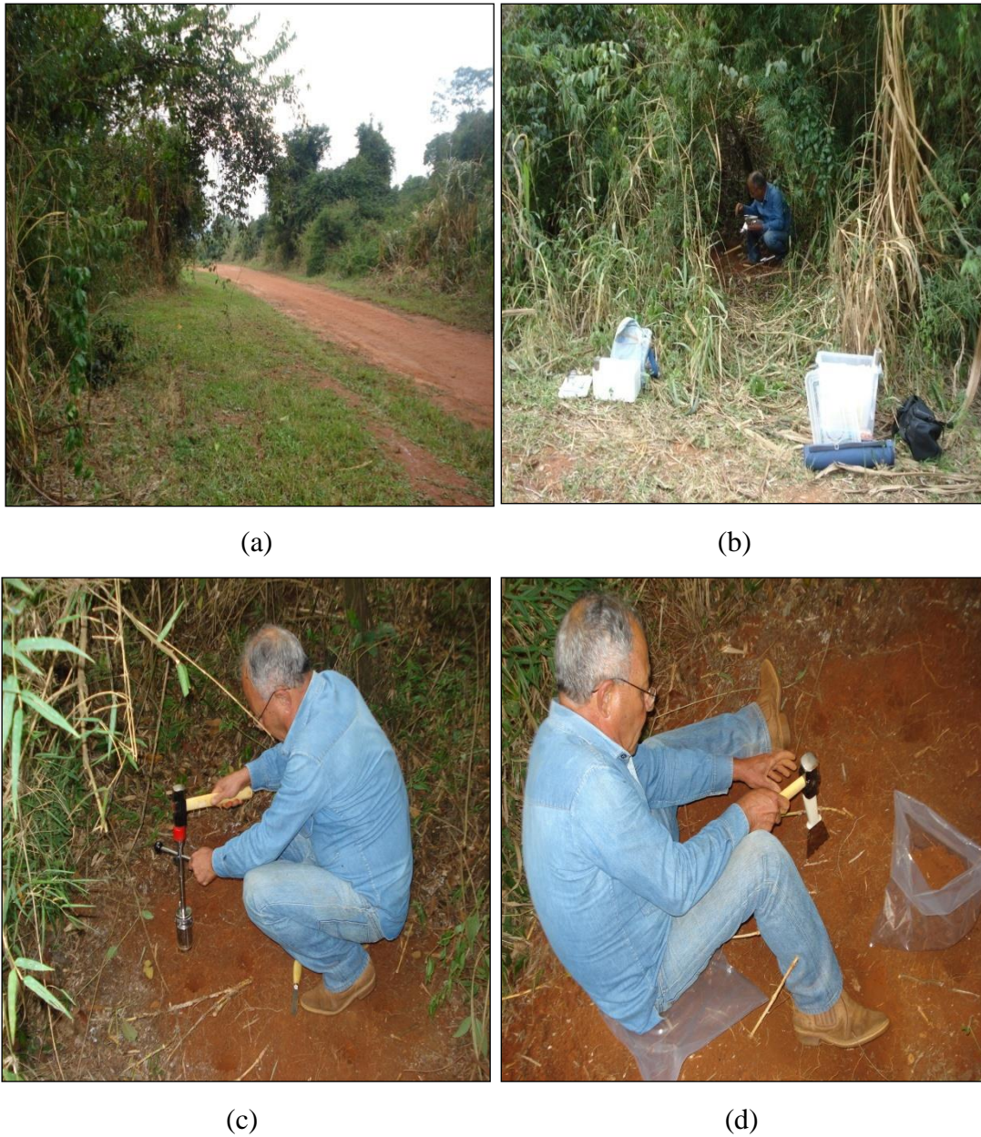
FIGURA 13– Fotos do solo de Piracicaba: (a) e (b) área da coleta do solo; (c) coleta do solo com estrutura não deformada; (d) coleta do solo com estrutura deformada
