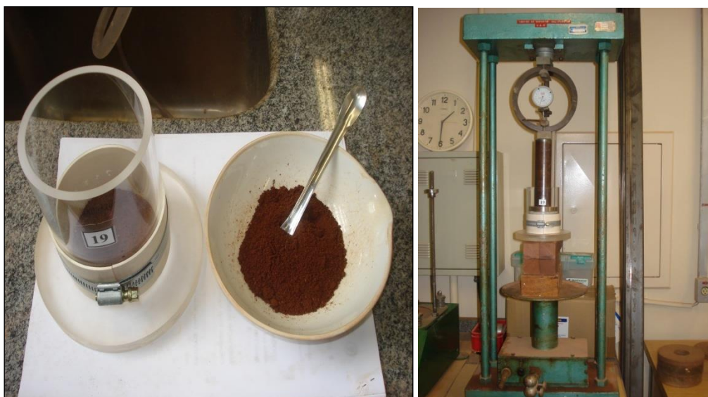
FIGURA 17 – Montagem de uma da coluna de solo
