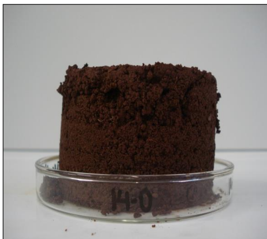
FIGURA 20 – Solo da coluna desmontada após separação da cinza de carvão
