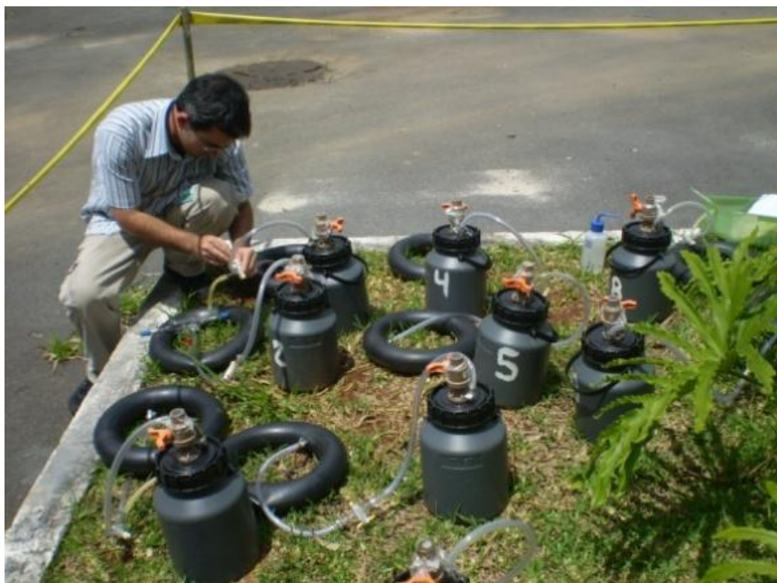
Figura 14: Coleta de biogás nos biodigestores Fonte: Elaboração própria
