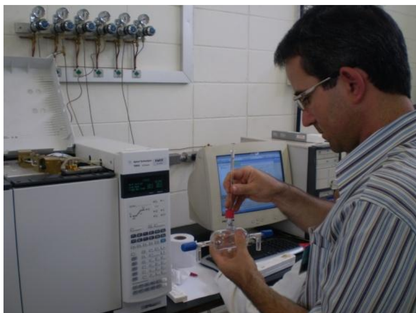
Figura 15: Injeção de biogás no cromatógrafo a gás Fonte: Elaboração própria
