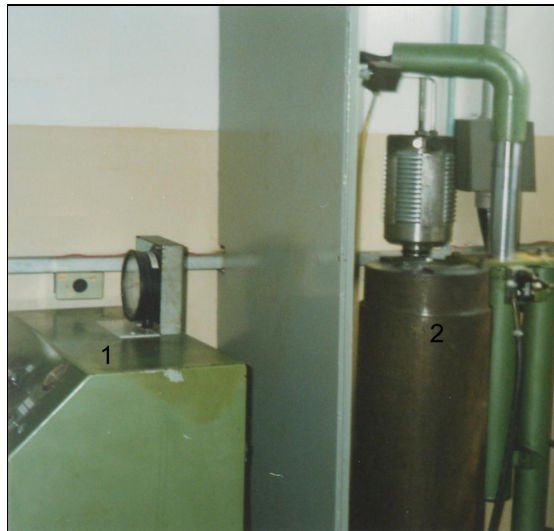
Figura 9 - Sistema de prensagem isostática. (1) painel de controle do equipamento, (2) vaso de pressurização.
