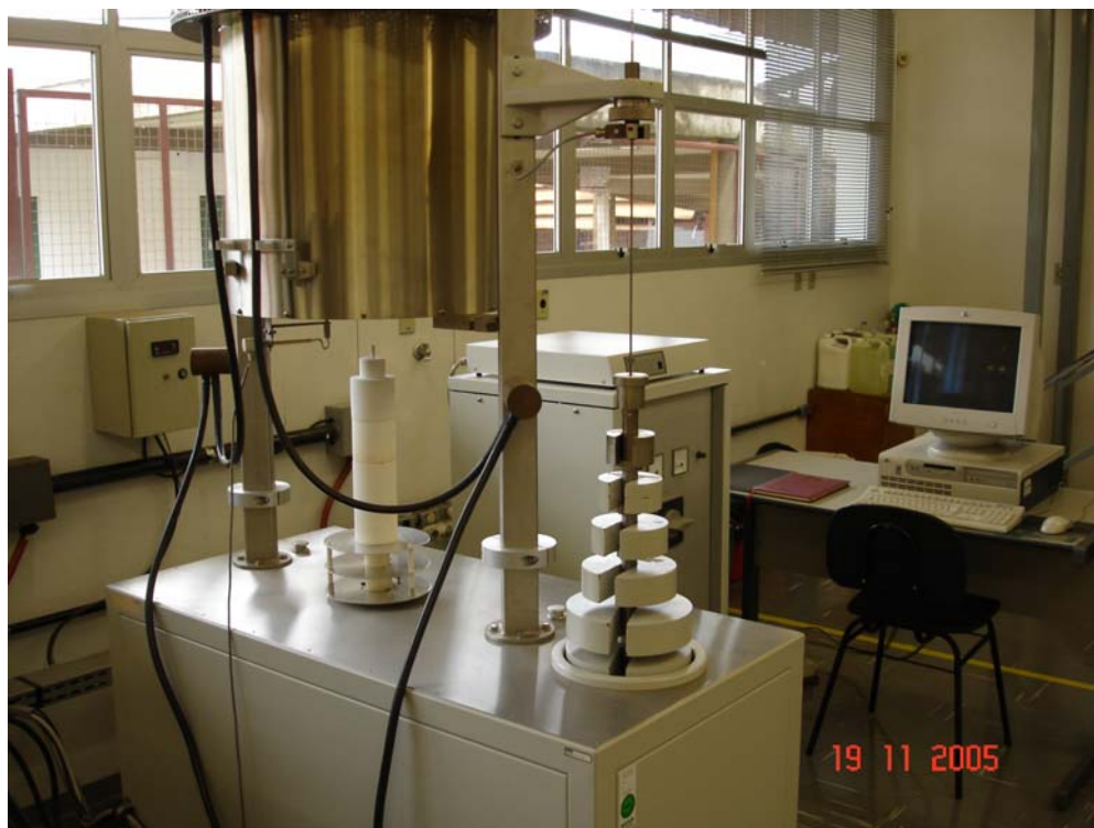
Figura 3.9 – Foto do equipamento utilizado para a determinação do coeficiente de dilatação térmica (GEMM/DEMa – UFSCar).
