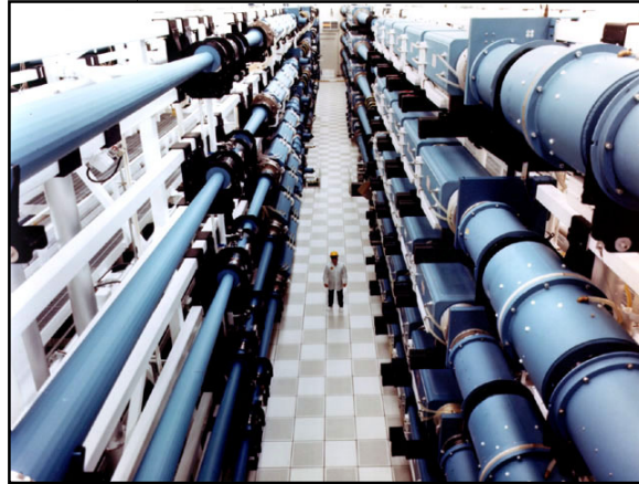
Figura 1 - Vista de 5 das 10 cadeias de amplificação de pulsos do laser NOVA do Laboratório Nacional Lawrence Livermore, logo após o término de sua construção em 1984. Cada cadeia de amplificação produzia um feixe com 74 cm de diâmetro, gerando aproximadamente 10 TW de potência em 1 nanossegundo (10 kJ por pulso).
