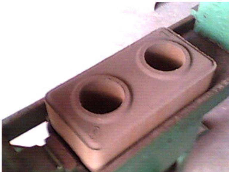
Figura 9. Tijolo com estrutura modular
