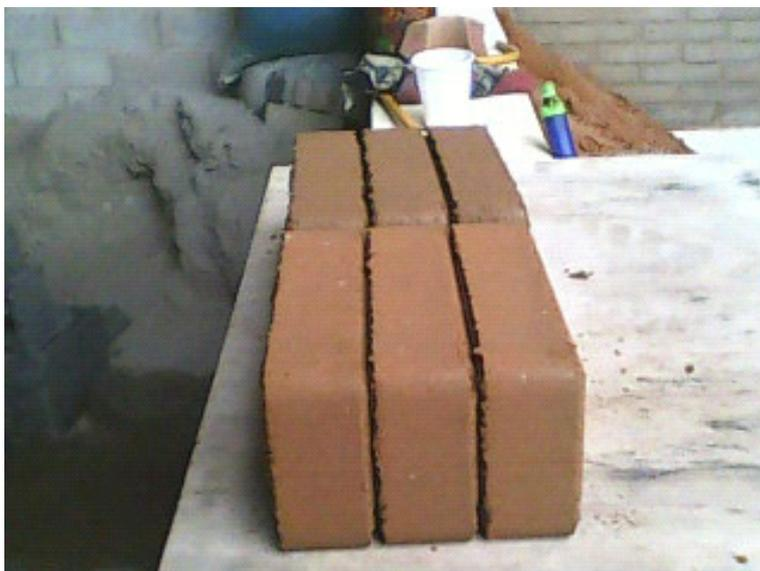
Figura 23. Tijolos de cinza/lodo/cimento/solo - lote 3 (frente) e tijolo de cinza/cal/lodo/solo - lote 04 (atrás)
