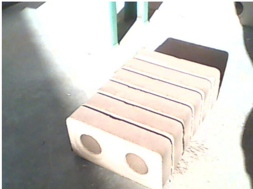
Figura 25. Tijolos de cinza/lodo/cimento/solo - lote 06
