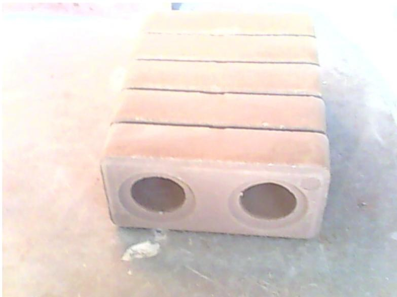
Figura 26. Tijolos de cinza/lodo/cal/solo - lote 07
