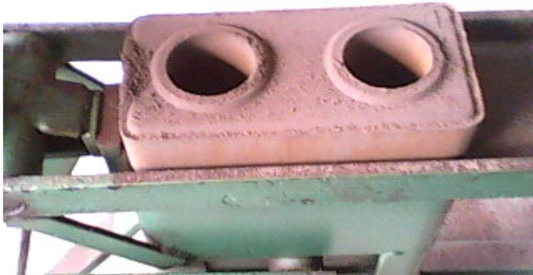
Figura 22. Tijolo de cinza/ lodo/cimento/solo- lote 02
