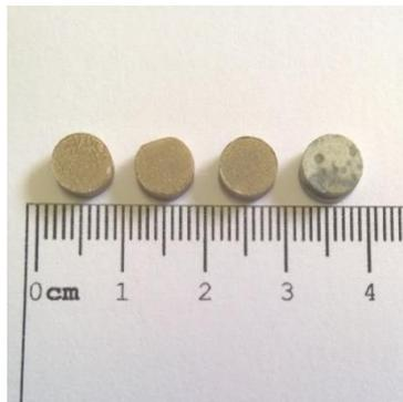
Figura 24: Fotografia das amostras contendo, da esquerda para a direita: SrTiO<sub>3</sub> + 0,025% mol Pr, SrTiO<sub>3</sub> + 0,050% mol Pr, SrTiO<sub>3</sub> + 0,075% mol Pr, e SrTiO<sub>3</sub> + 1% mol Pr.
