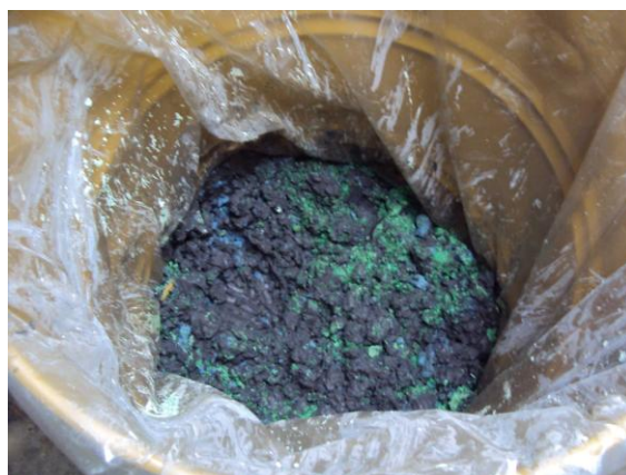
FIGURA 21 – Acondicionamento de lodo em tambor, com saco plástico, porém, sem rotulagem nas paredes externas (não visível)
