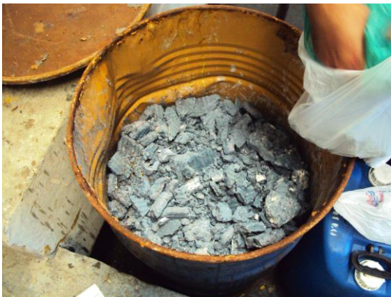
FIGURA 18 – Acondicionamento de lodo em tambor, sem plástico
