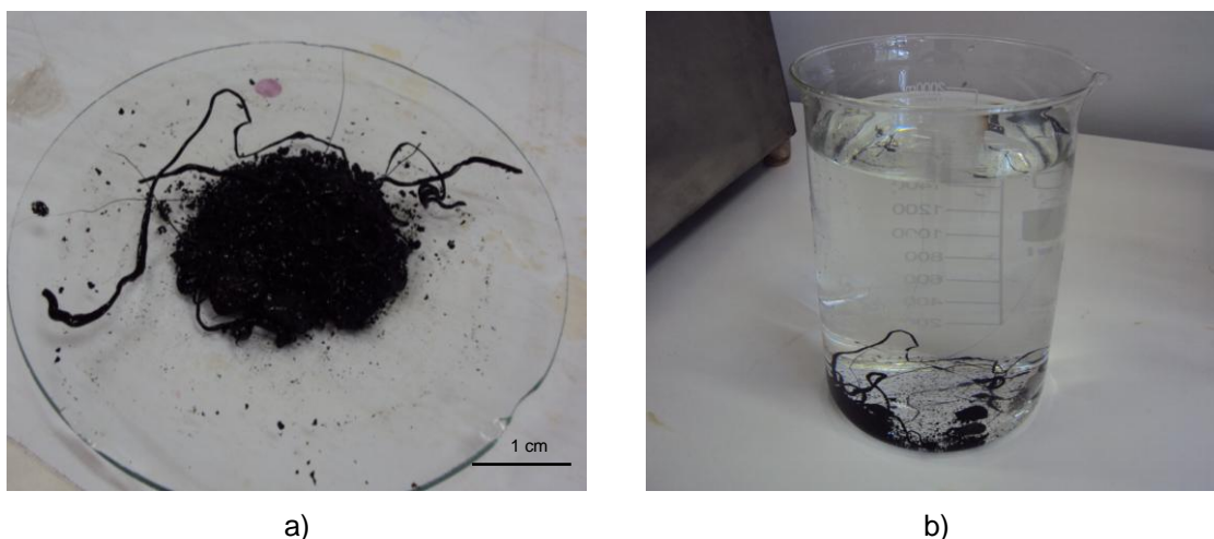
FIGURA 58 – Formação de frita com incorporação de RSG 5: a) Frita obtida ( F 24R5 27N 0,5C ) e b) Líquido incolor recolhido após vertimento
