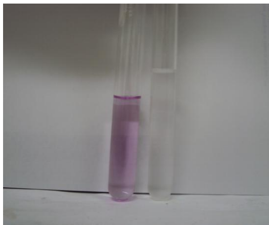
FIGURA 59 – Ensaio qualitativo para verificar presença de cromo. À esquerda: tubo de ensaio com solução padrão contendo cromo e à direita: tubo de ensaio com a amostra
