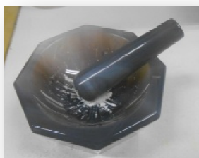
FIGURA 31 – Maceramento e homogeneização das amostras em KBr.
