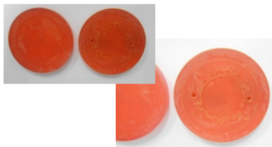
FIGURA 42 – Janela espectral de KRS-5 danificada. Fonte: Elaborada pela autora
