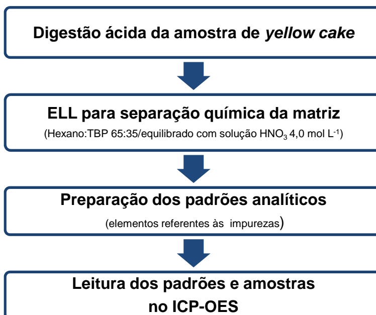
FIGURA 38 – Procedimento geral de quantificação de impurezas em matriz de urânio por ICP-OES
