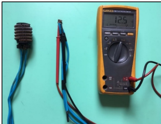
Apêndice - Figura 123 - Carga resistiva para levantamento do comportamento elétrico do painel solar
