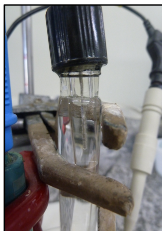
Apêndice - Figura 118 - Formação de bolhas na calibração do eletrodo de referência
