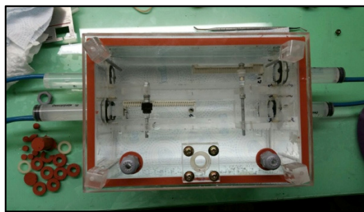
Apêndice - Figura 17 - Sistema de vedação com silicone térmico vermelho
