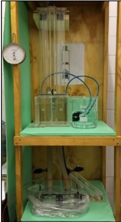
Figura 58 - Conjunto Eletrolisador, Reservatórios e Tubos graduados
