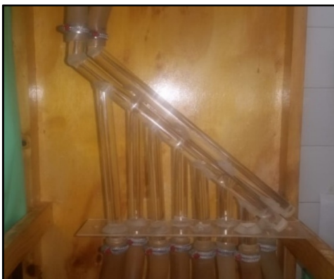
Figura 64 - Montagem dos tubos coletores
