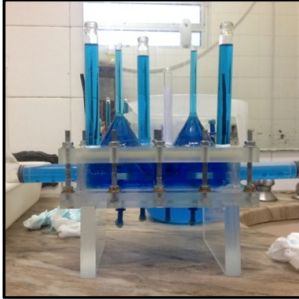
Apêndice - Figura 59 - Eletrolisador com produção separada dos gases preenchido com água com corante
