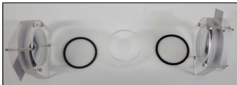
Figura 49 - Vedação entre tubo com eletrólito e eletrodos
