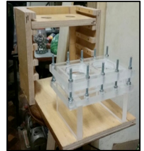
Apêndice - Figura 62 - Suporte para o eletrolisador e tanque de refrigeração
