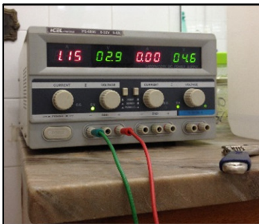
Apêndice - Figura 66 - Fonte de alimentação CC para eletrólise
