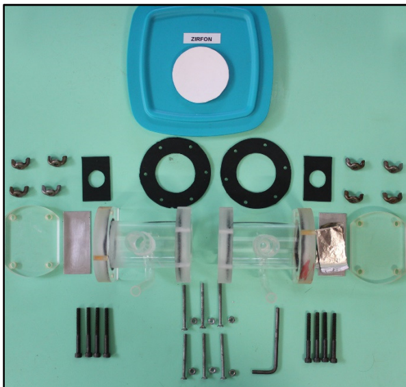
Figura 53 - Sequência de montagem da célula única com membrana separadora dos gases produzidos
