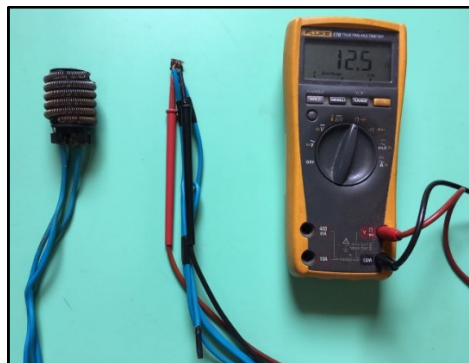
Figura 43 - Carga resistiva para levantamento do comportamento elétrico do painel solar
