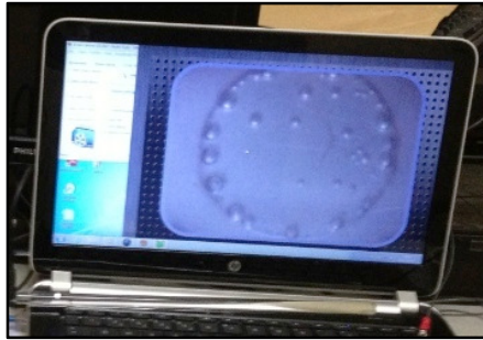
Apêndice - Figura 54 - Imagem da superfície do eletrodo no momento da nucleação das bolhas
