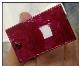
Apêndice - Figura 23 - Cobertura de esmalte: a janela central foi protegida com papel e depois retirada
