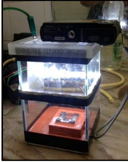
Apêndice - Figura 38 - Camêra acoplada à tampa do eletrolisador
