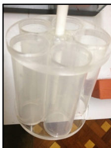
Apêndice - Figura 46 - Dispositivo para limpeza das bolhas suspensas no eletrólito
