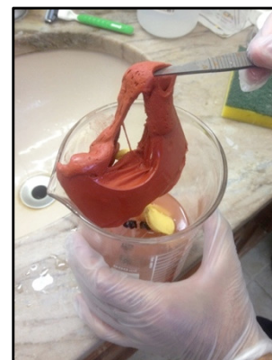
Apêndice - Figura 121 - Silicone em solução de KOH a 4M
