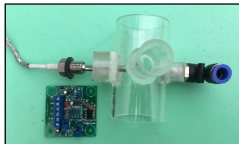
Figura 83 - Sistema de medição de temperatura
