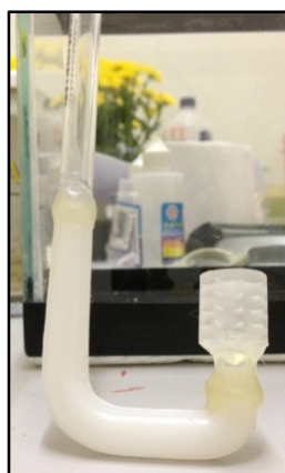
Apêndice - Figura 49 - Sifão para injeção de ar
