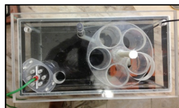
Apêndice - Figura 44 - Furação para o eletrodo de referencia a esquerda e para o dispositivo de limpeza a direita
