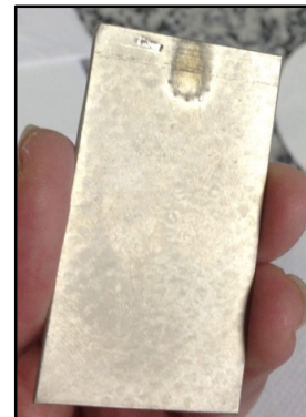
Apêndice - Figura 106 - Placa com dupla camada: níquel sobre cobre sobre substrato de aço inox
