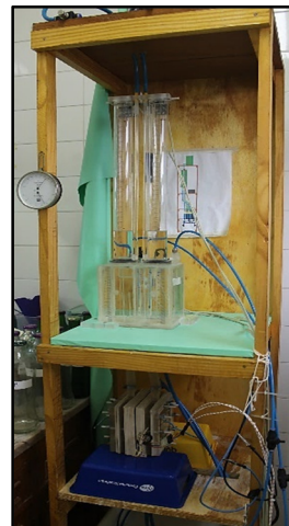
Figura 79 - Montagem do sistema para produção do hidrogênio com eletrolisador de 1 célula
