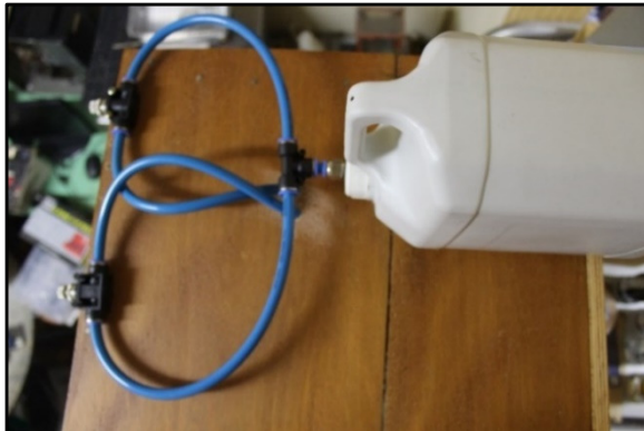
Figura 62 - Tanque de reposição de água destilada
