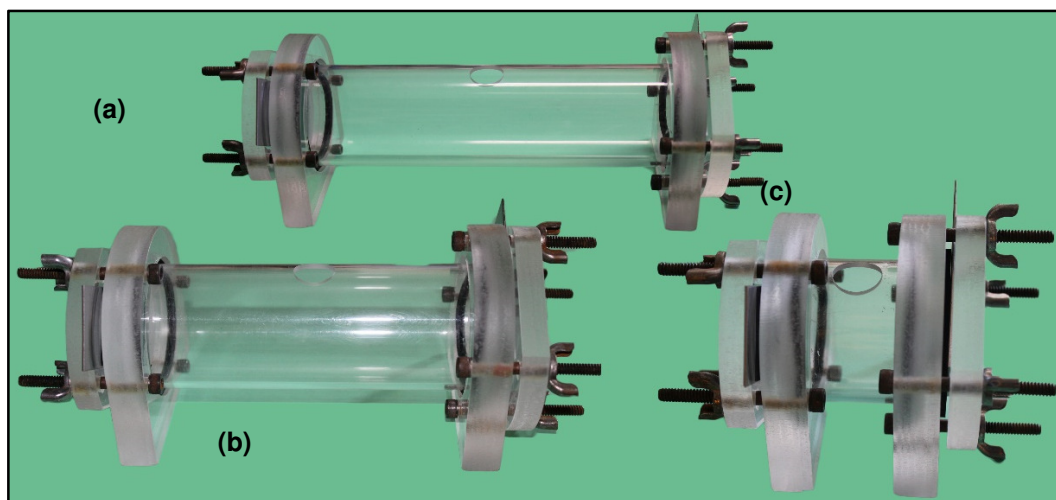
Figura 46 - Eletrolisadores montados com tubos de diversos comprimentos
