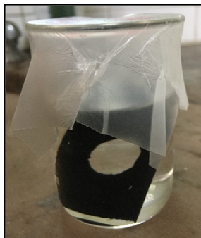
Apêndice - Figura 122 - Borracha de vedação em solução alcalina KOH - 5 M
