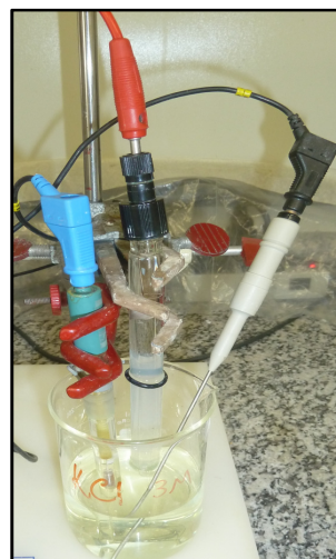
Apêndice - Figura 117 - Calibração de eletrodo de referência de hidrogênio
