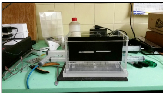
Apêndice - Figura 16 - Tela preta no interior do eletrolisador para visualização das bolhas de gases
