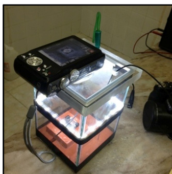
Apêndice - Figura 34 - Acoplamento da câmara na tampa
