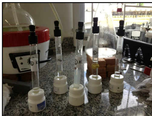
Figura 93 - Eletrodo de referência de hidrogênio de baixo custo para uso em meio alcalino
