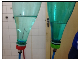
Apêndice - Figura 64 - Reservatórios de Oxigênio (esquerda) e Hidrogênio (direita)
