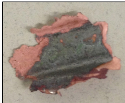
Apêndice - Figura 105 - Amostra da cobertura de níquel sobre cobre obtida
