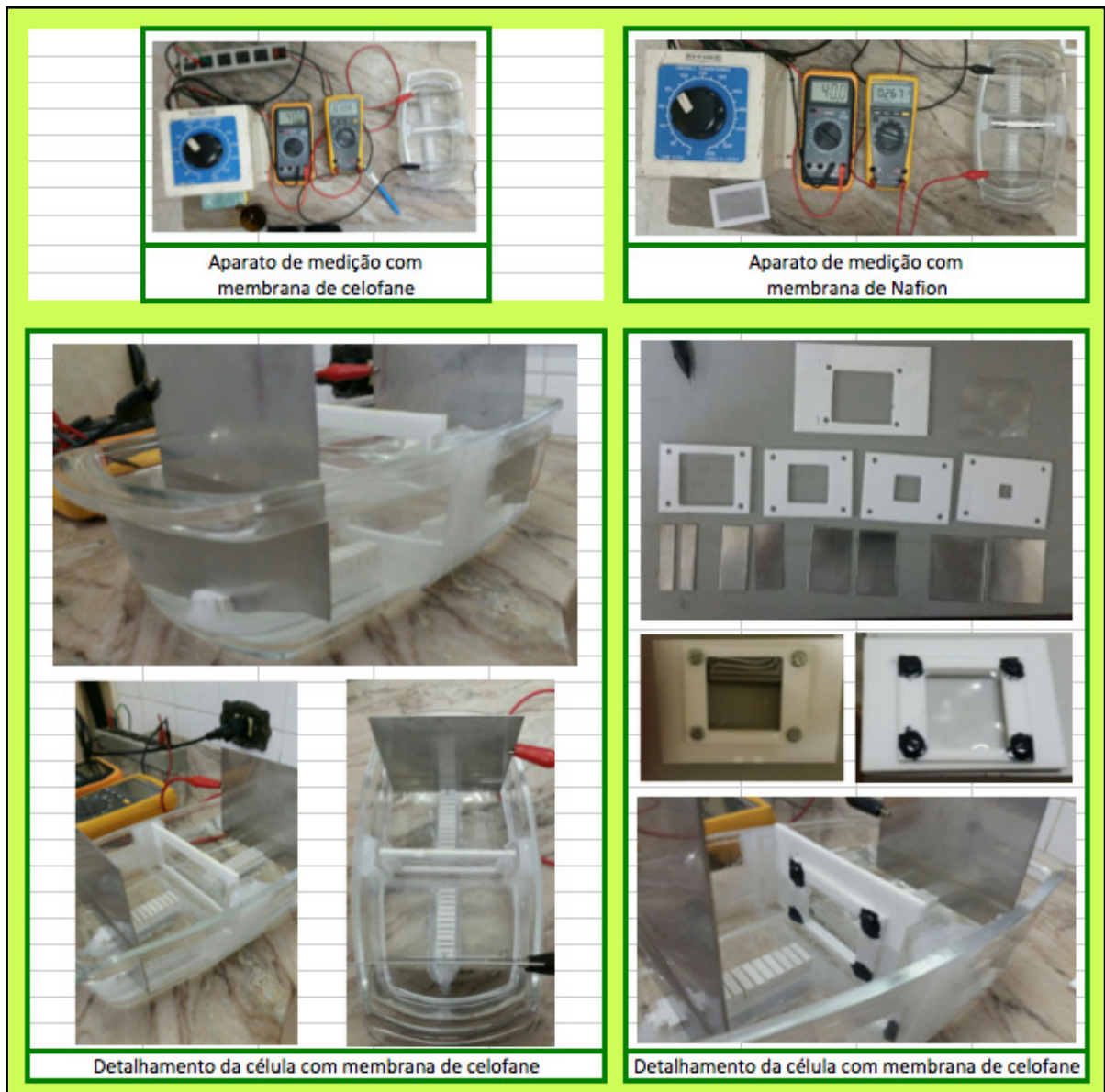
Apêndice - Figura 6 - Aparato experimental para levantamento da curva de resistividade do eletrólito
