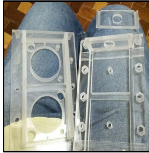
Apêndice - Figura 60 - Detalhes da tampa (esquerda) e fundo (direita) do eletrolisador
