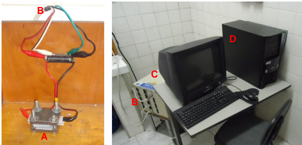
FIGURA 9 – Bateria de Ni-HM (A), conexões dos eletrodos no Arbin (B), Arbin BT4 (C) e PC-IBM para aquisição dos dados elétricos (D).
