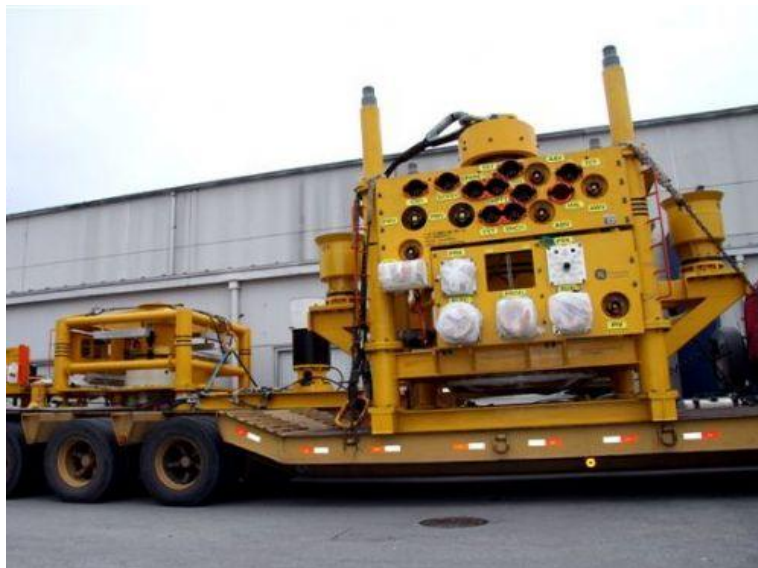
Figura 1: Ilustração da ANM no chão de fábrica sendo transportada [imagem cedida pela General Eletric ]
