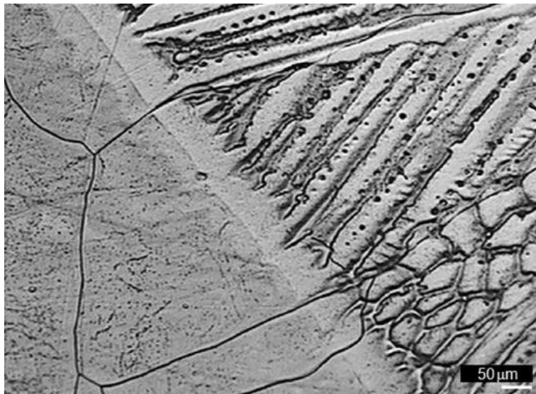
Figura 13: Crescimento epitaxial próxima a linha de fusão [23].
