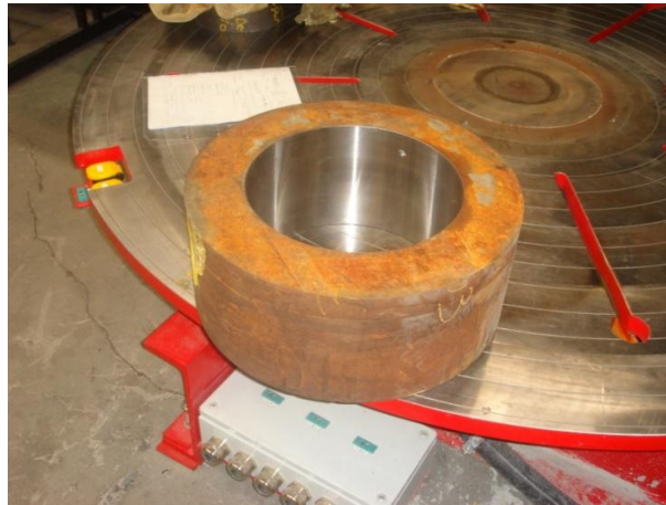
Figura 28: Detalhe da montagem da amostra no dispositivo para execução da soldagem TIG.
