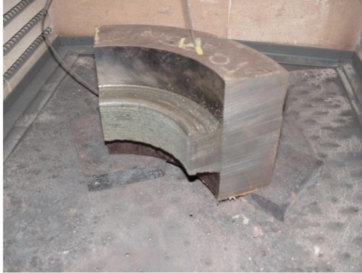
Figura 35: Imagem da montagem das peças para o tratamento térmico de alívio de tensões com indicação do termopar de contato.
