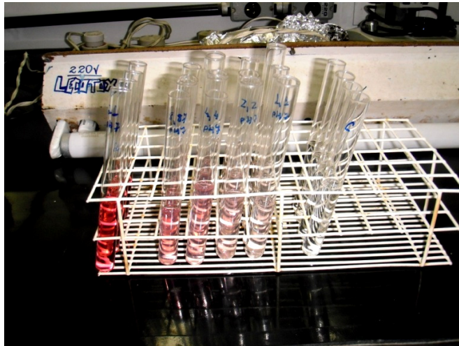
FIGURA 16 - Diluição de uma amostra durante o ensaio de toxicidade com Daphnia similis
