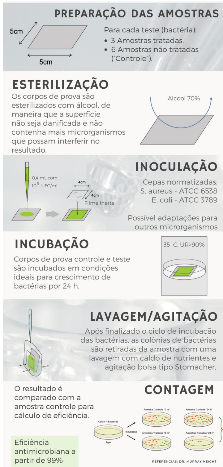
Figura 12 - Procedimento norma JIS Z 2801.
