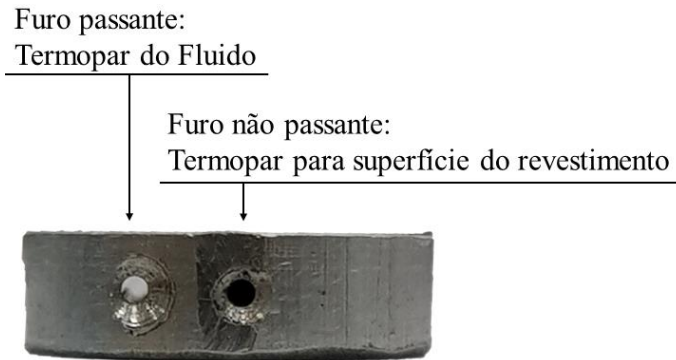
Figura 18 – Representação do furo passante e não passante no disco.
