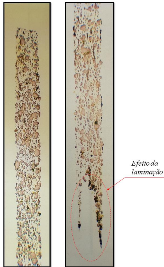
Figura 41 - Metalografia da placa combustível com efeito de laminação numa extremidade.
