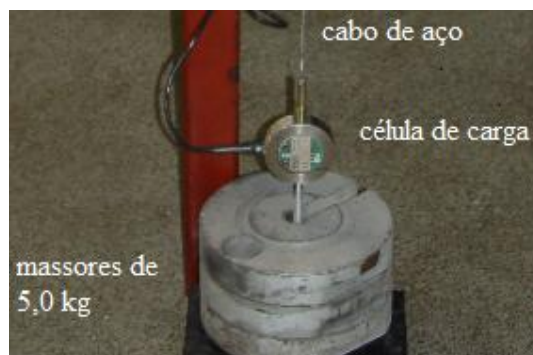
Fotografia 30. A célula de carga foi posicionada na haste de suporte dos massores. Fonte: Acervo próprio (2008).
