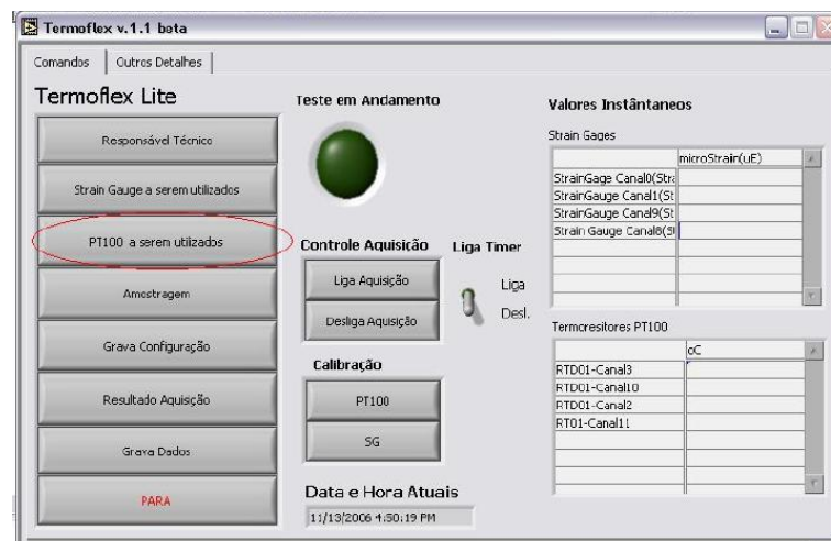
Fotografia 43. Painel de controle do software TERMOFLEX, utilizado para a coleta de dados da placa de concreto.
