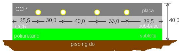
Desenho 10. Vista em corte da seção transversal da placa, com sistema refrigeração / aquecimento. Todas as medidas estão em centímetros.
