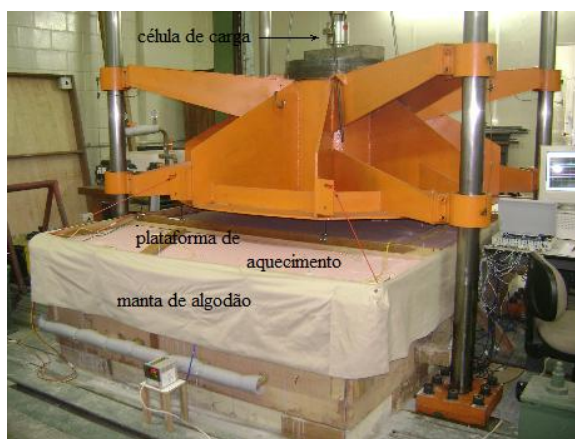
Fotografia 25. Placa sendo submetida a teste de temperatura com sensores ligados no sistema de aquisição de dados.
