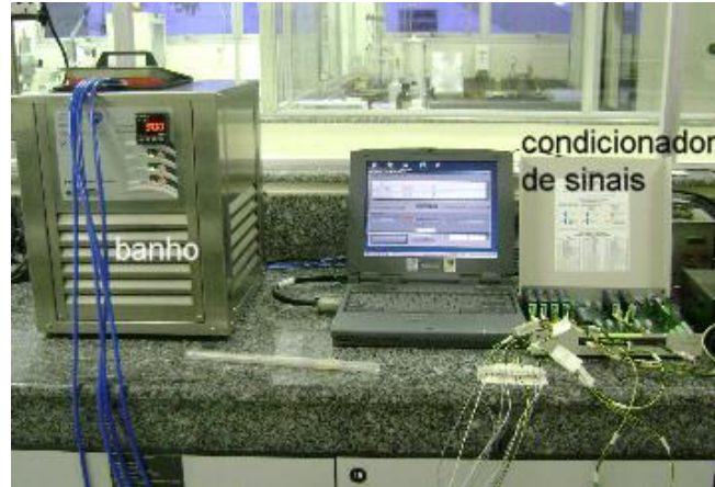
Fotografia 35. Conjunto de calibração envolvendo banho termostático, termômetros (em azul), condicionadores de sinal e notebook com placa de aquisição.
