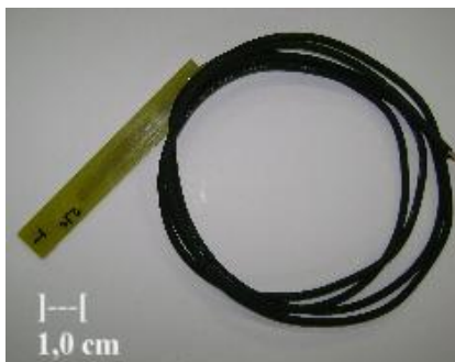
Fotografia 7. Sensor de embutimento pronto para uso. Fonte: Acervo próprio (2007).
