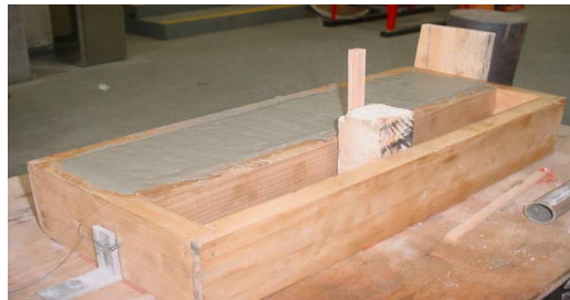
Fotografia 5. Aspecto do molde com a vigota moldada. Fonte: Acervo próprio (2005).
