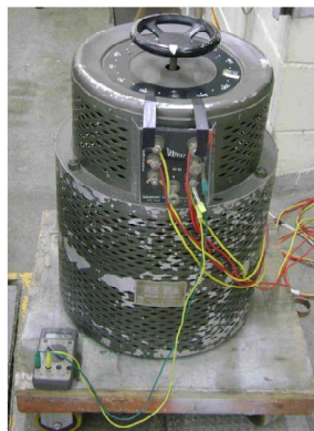
Fotografia 12. Aspecto do autotransformador (variável) responsável por estabelecer as tensões sobre as resistências da placa de aquecimento.
