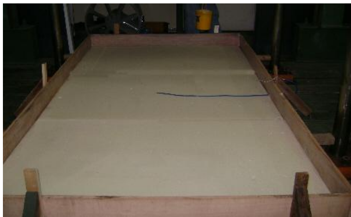
Fotografia 15. Aspecto do molde já com a placa de poliuretano colocado e um termômetro no centro para leitura da temperatura no subleito (TE14).
