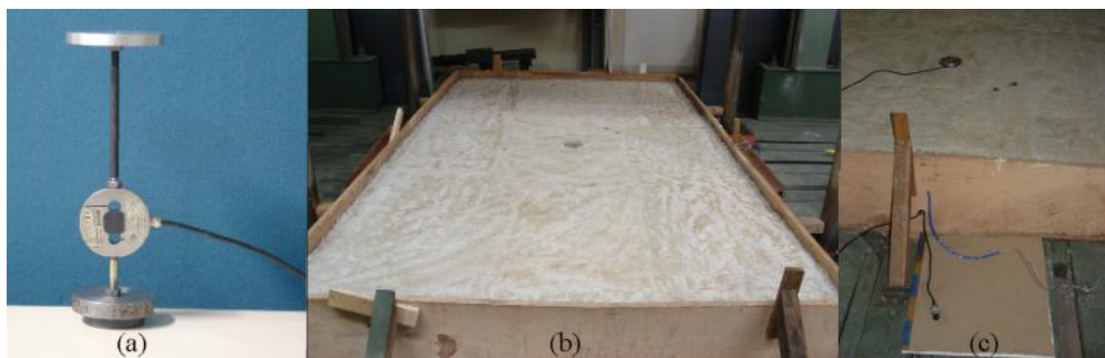
Fotografia 22. (a) célula de carga com base magnética para fixação no piso da laje de reação, (b) base com a cavidade de abrigo (poço) da célula de carga, (c) célula de carga posicionada dentro da cavidade.
