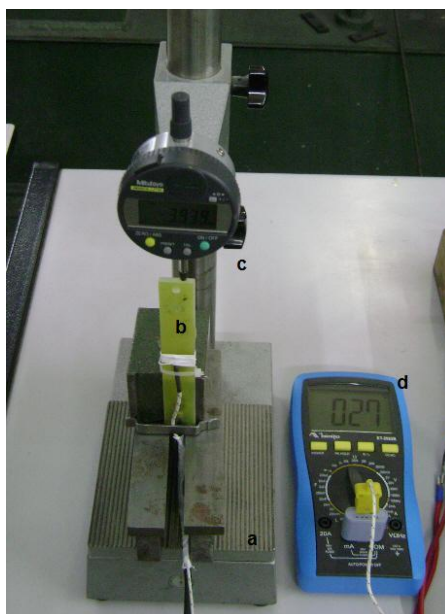
Fotografia 28. Dispositivo para medida da dilatação linear do TVE. (a) base, (b) TVE, (c) micrômetro e (d) multímetro. Fonte: Acervo próprio (2008).
