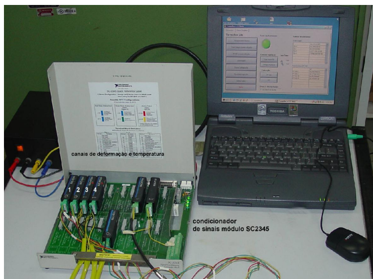
Fotografia 45. Disposição do sistema de gerenciamento e aquisição de sinais TERMOFLEX. Fonte: Acervo próprio (2006).
