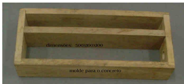
Fotografia 2. Molde utilizado para confecção do CP e testes de embutimento, dimensões 100,0x100,0x500,0mm.
