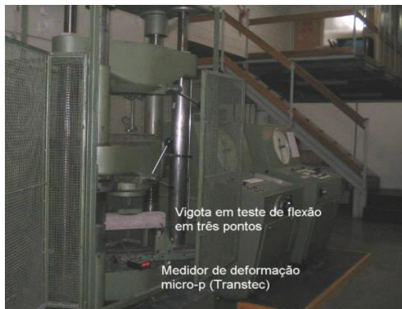
Fotografia 6. Teste de flexão para verificação da sensibilidade da célula de embutimento. Fonte: Acervo próprio (2005).
