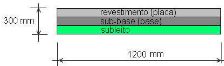
Desenho 50. Dimensões da placa de concreto. Fonte: Acervo próprio (2006).
