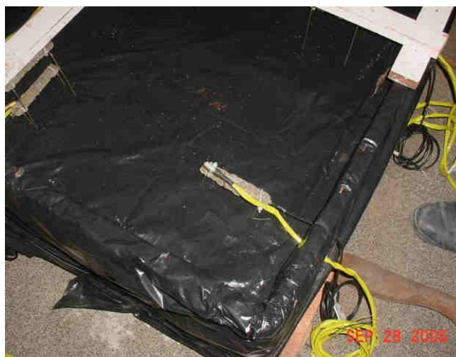
Fotografia 42. Detalhe de um conjunto termômetro e célula de deformação presos no cavalete. Fonte: Acervo próprio (2006).
