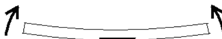
Desenho 33. CE sendo solicitada na flexão com extensômetro posicionado na parte inferior da CE.
