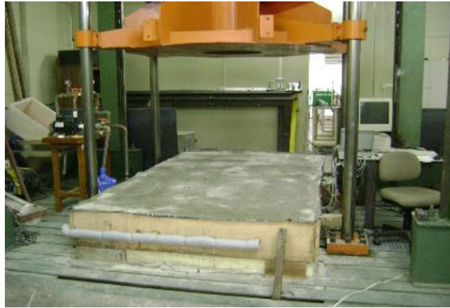
Fotografia 21. Aspecto da placa já terminada após 28 dias, tendo sob ela a laje de reação e sobre ela uma máquina hidráulica para testes de carregamento estático.
