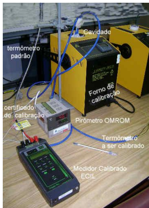
Fotografia 36. Disposição dos equipamentos utilizados para calibração do termômetro e do pirômetro.
