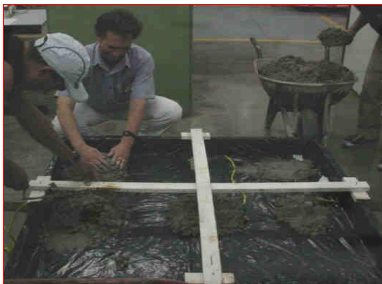
Fotografia 43. Proteção dos sensores com concreto antes da colocação da totalidade de massa. Isso evita que ocorra algum deslocamento dos sensores, devido à pressão que a massa impõe sobre esses componentes.
