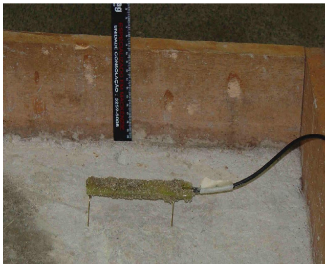
Fotografia 41. Vista de um sensor de deformação apoiado sobre um cavalete e, no detalhe, mostrando a dimensão da capa de revestimento a ser colocada. Fonte: Acervo próprio (2006).
