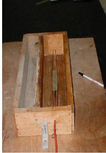
Fotografia 4. Molde para construção da vigota de testes preliminares. Fonte: Acervo próprio (2005).
