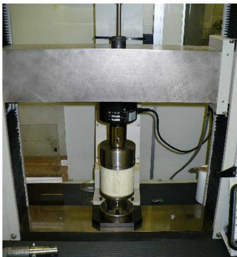
Fotografia 17. Detalhe da amostra de poliuretano sob teste de compressão. Fonte: Acervo próprio (2008).
