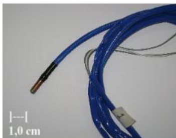
Fotografia 10. Aspecto do termômetro acabado utilizado para as medições de temperatura. Fonte: Acervo próprio (2007).
