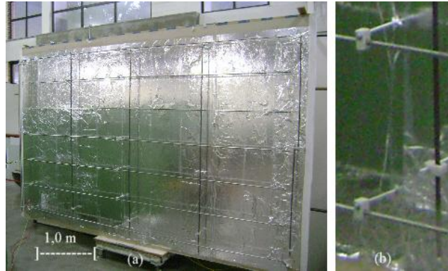
Fotografia 11. (a) plataforma de aquecimento revestida com lâmina de alumínio, (b) detalhe dos isoladores cerâmicos utilizados na montagem dos elementos resistivos (resistências) na plataforma.
