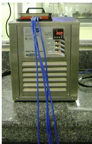
Fotografia 33. Banho termostático com quatro sensores em teste. Fonte: Acervo próprio (2008).
