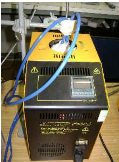
Fotografia 34. Forno utilizado para a calibração dos termômetros. Fabricante ECIL Temperatura Industrial Modelo Júpiter 650. Fonte: Acervo próprio (2008).
