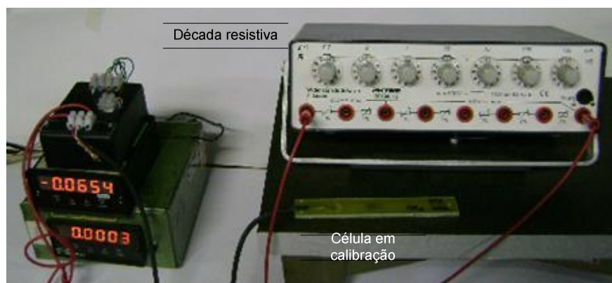
Fotografia 32. Disposição dos equipamentos utilizados nos testes de calibração por meio de um shunt resistivo.
