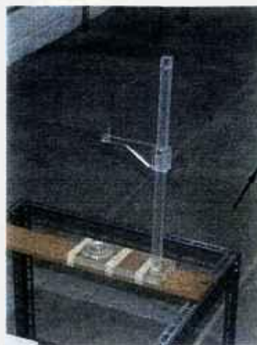
Figura 3.5 - Suporte empregado para fixação da fonte de ^{60}\text{Co} .
