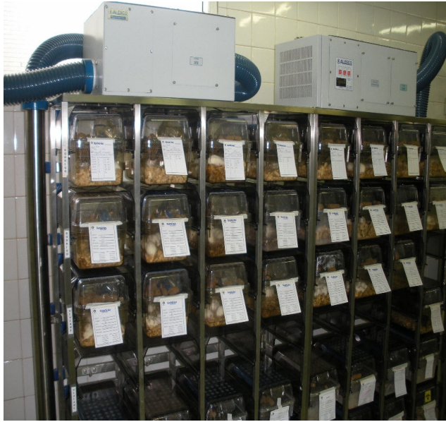
FIGURA 6: Rack ventilada ALESCO®, com 56 mini-isoladores utilizada para manutenção dos casais em reprodução.
