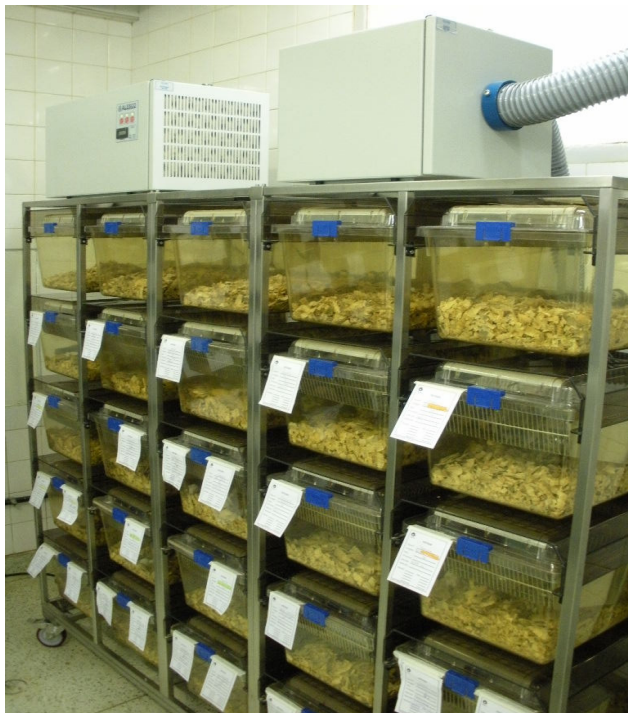
FIGURA 7: Rack ventilada ALESCO®, com 25 mini-isoladores com capacidade para até 30 camundongos para manutenção dos estoques de machos e fêmeas dos experimentos.
